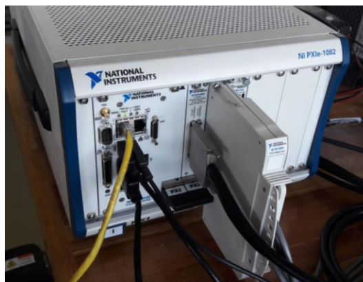
Figura 34. Computadora industrial PXI con los módulos incorporados.
