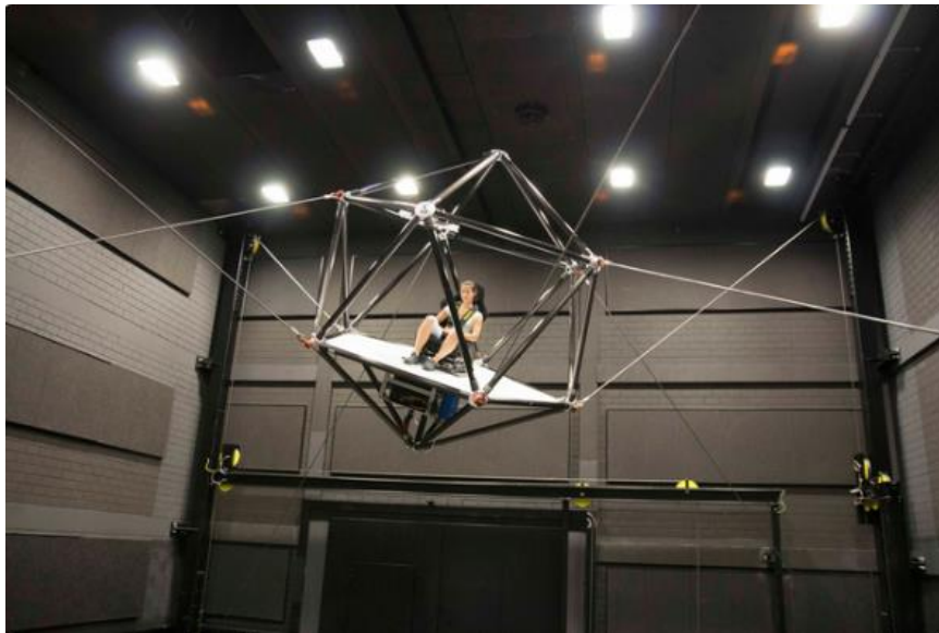
Figura 3. Cable robot de Cyber Labs desarrollado para simulación. Tomado de [11].
