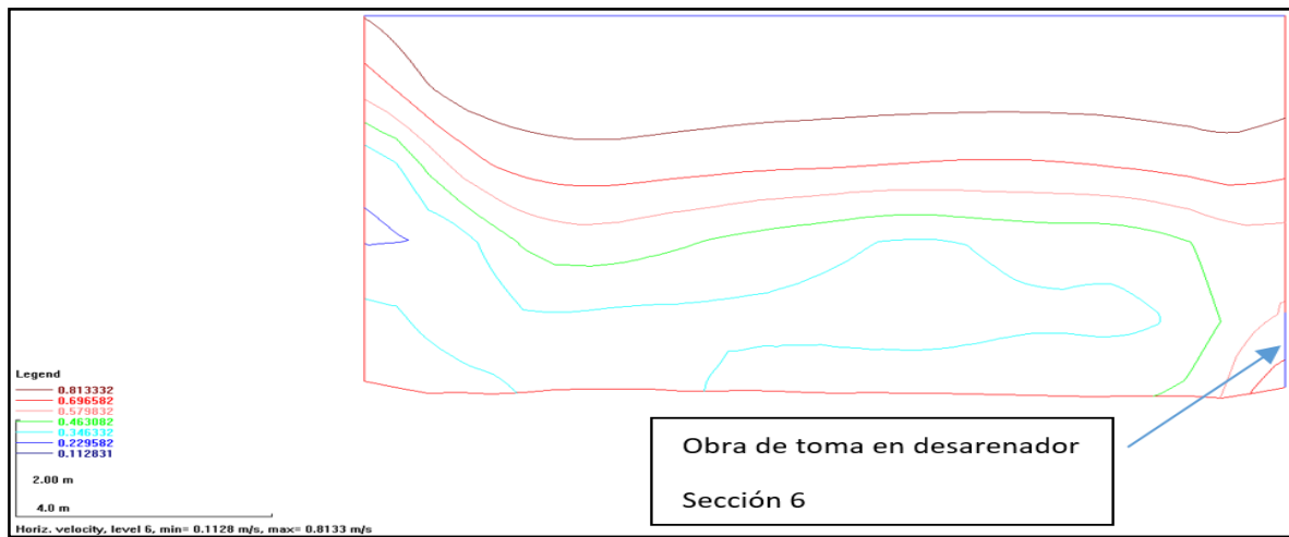
Fig. 46 Sección transversal en el desarenador, velocidades horizontales.
