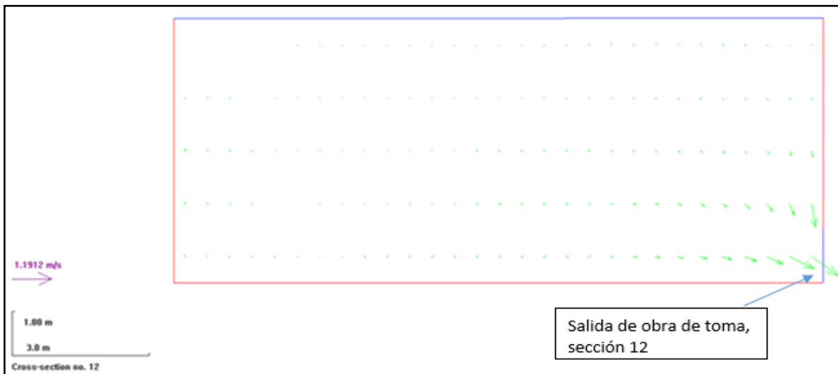
Fig. 57 Vista de los vectores de velocidad en la sección transversal del desarenador en la sección 12 (con obra de toma), ubicado en el lado derecho del canal.
