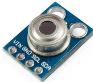
**Figura 48.** Sensor infrarrojo de temperatura MLX90614 [60]
