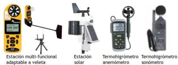
**Figura 20.** Estaciones meteorológicas portátiles [35]
