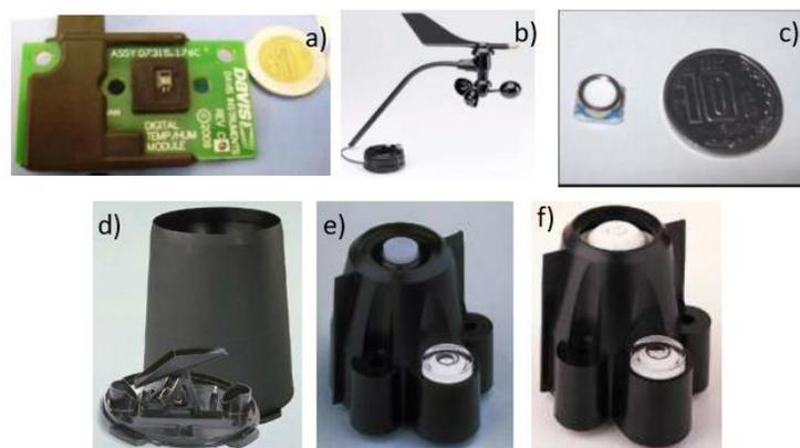
**Figura 26.** Sensores: a) Termohigrómetro, b) Anemómetro, c) Barómetro, d) Pluviómetro, e) Piranómetro, f) Sensor de radiación ultravioleta [41]
