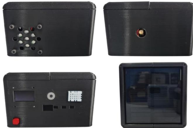
**Figura 63.** Vistas laterales, superior y frontal del contenedor para la estación de monitoreo
