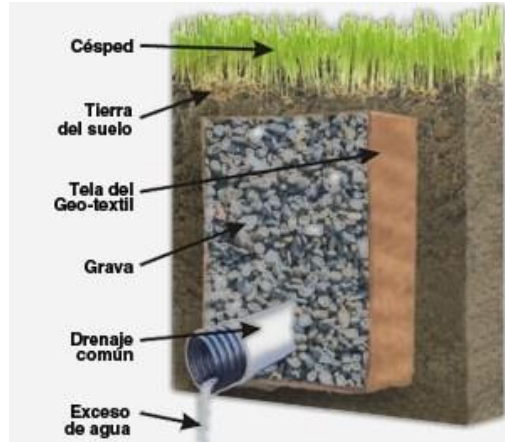
Figura III.XVII. Dren filtrante FUENTE: (Abellán, 2016)
