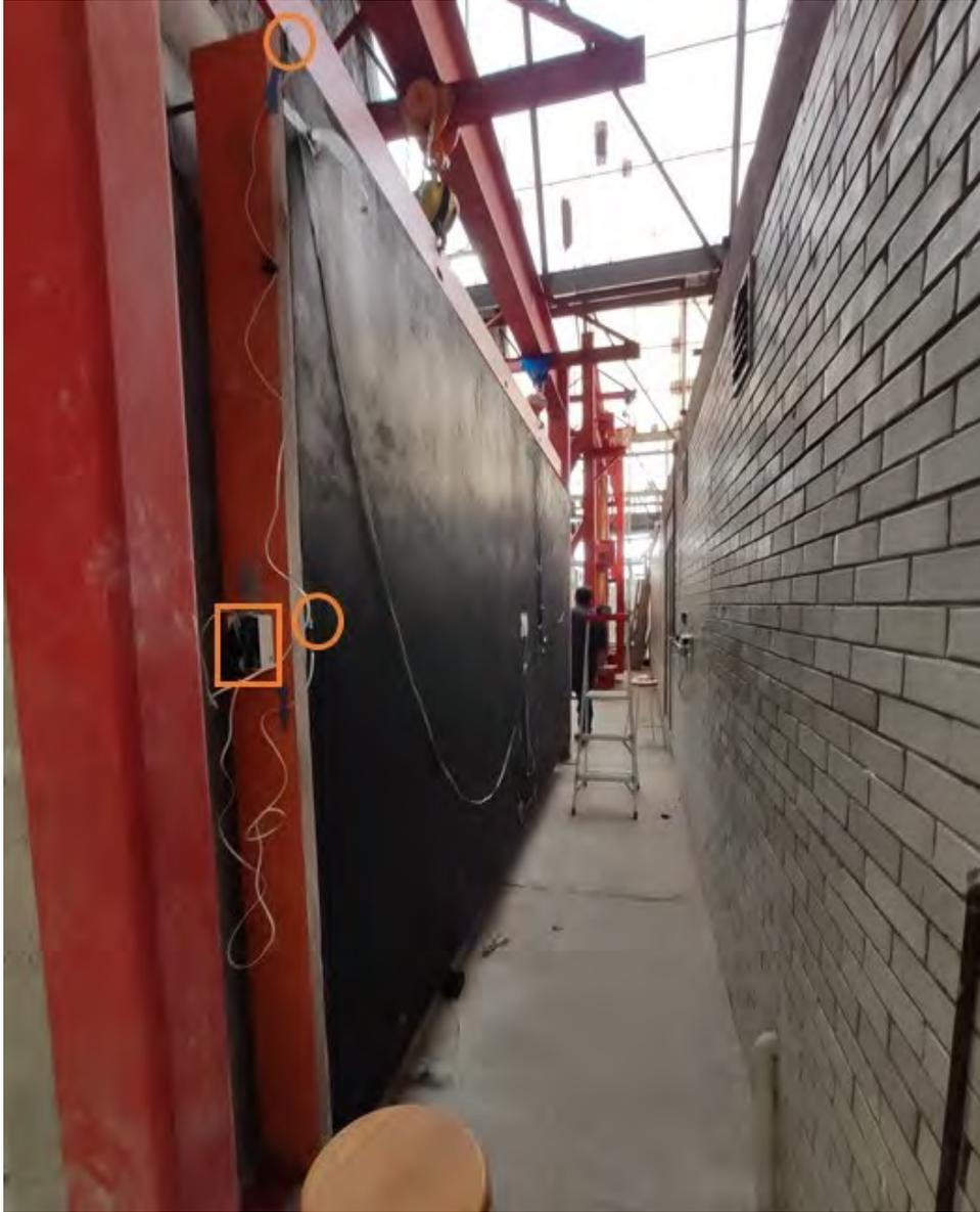
Figura 5.35: Sensores colocados en la replica del panel
