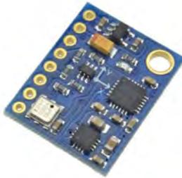
Figura 3.7: Unidad de Medición inercial GY-87<sup>[37]</sup>
