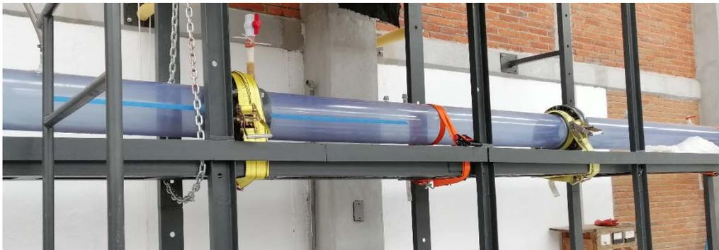
Figura 5.8. Sujeción del conducto de PVC transparente a la plataforma de apoyo con cintas de tensión
