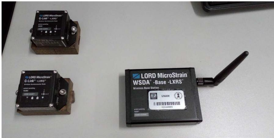
Figura 5.6. Sensores inalámbricos y base receptora
