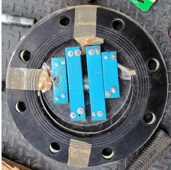
Figura 5.15. Compuerta del 10% de apertura reforzada con placas de acero y dañada en los costados
