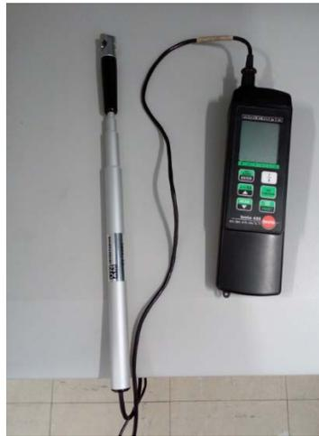
Figura 5.5. Anemómetro testo 435
