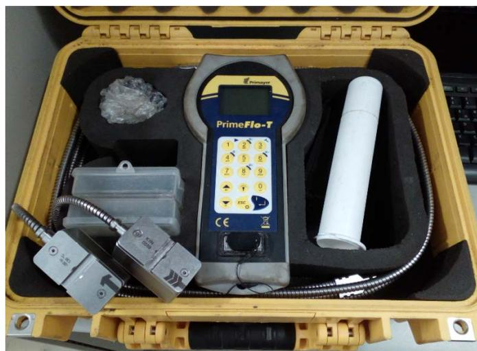
Figura 5.4. Medidor de flujo ultrasónico PrimeFlo-T
