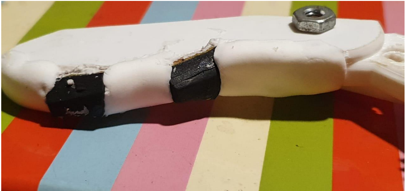
Ilustración 78 Foamy cubriendo alrededor del hule sobre un dedo.
