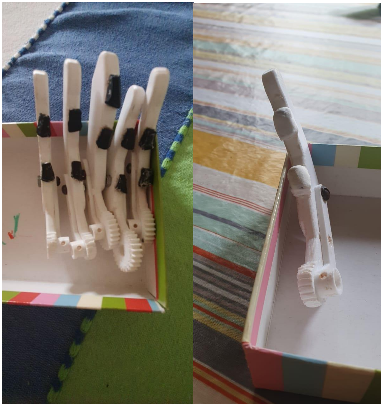
Ilustración 77 Hule de llanta colocado a todos los dedos y recubrimiento de foamy sobre un el hule en un dedo.
