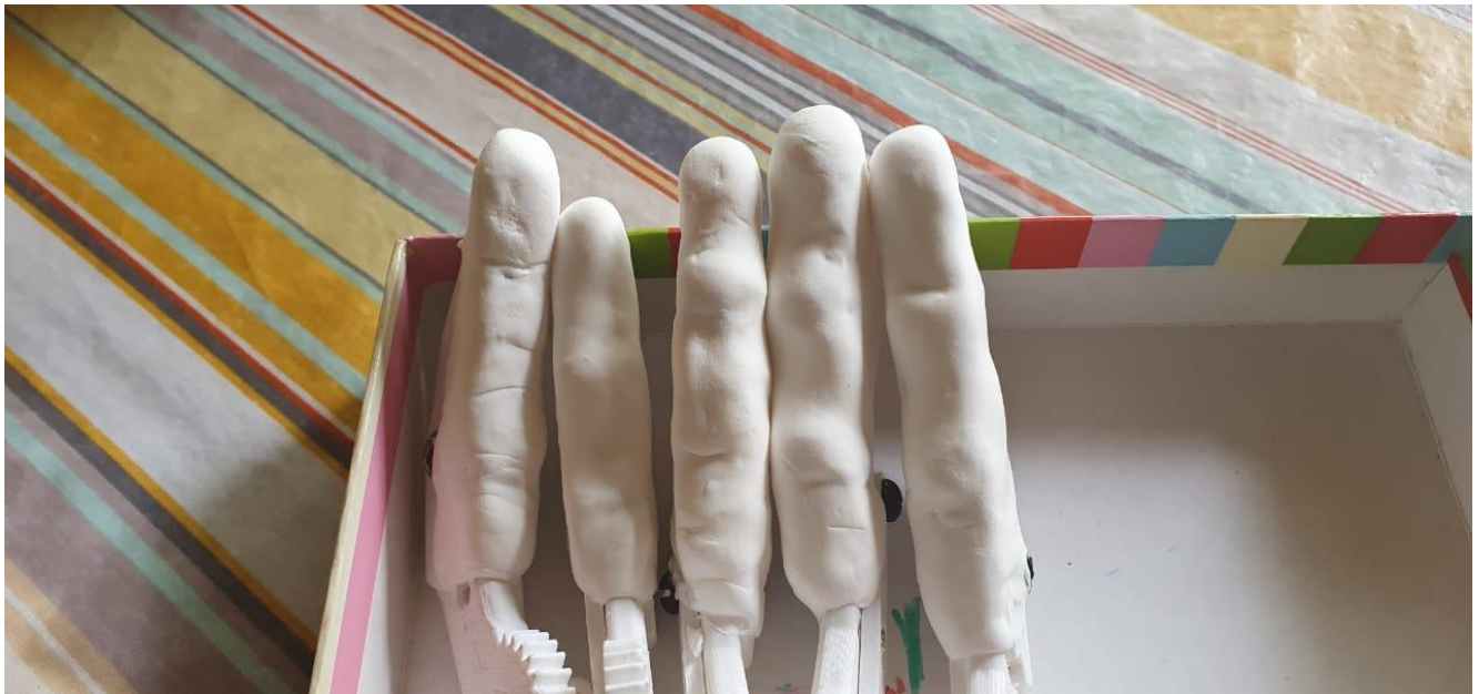
Ilustración 79 Foamy moldeado para tomar una apariencia similar a la piel de un dedo cubriendo el hule de llanta colocado en cada dedo.
