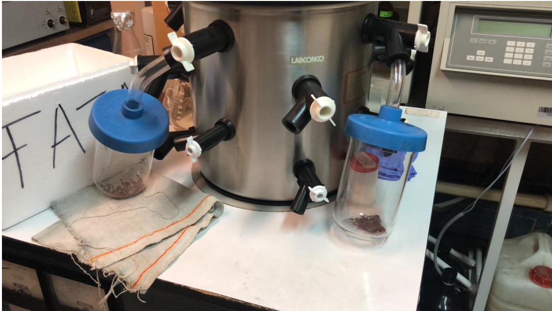
Figura 10 Muestra de AuNP después de un día de liofilización, apunto de secarse completamente. Equipo del laboratorio B-02 del Dr. Manuel Aguilar en el INB.
