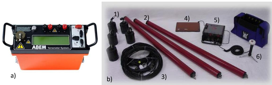
Figura 11. a) Resistivímetro ABEM modelo Terrameter SAS100. b) Equipo de medición para el MT: 1) Electrodos, 2) bobinas magnéticas, 3) cables magnéticos, 4) computadora portátil, 5) consola Phoenix MTU-2000, 6) GPS.
