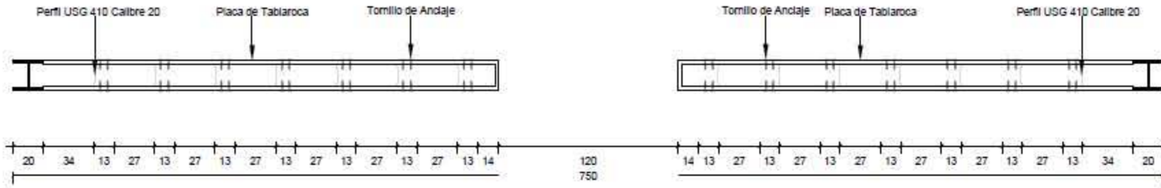
Montaje de Muro de Tablaroca en Planta.
