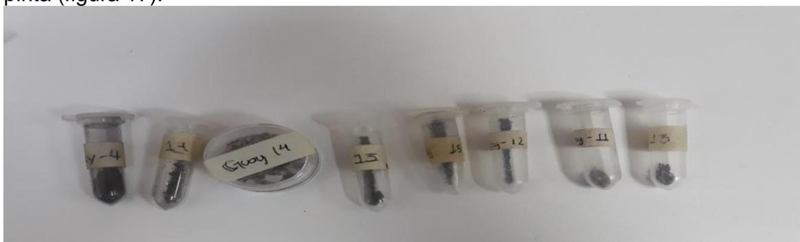
**Figura 17.** Concentrados de minerales puros de diferentes sulfuros para el análisis isotópico del azufre.
