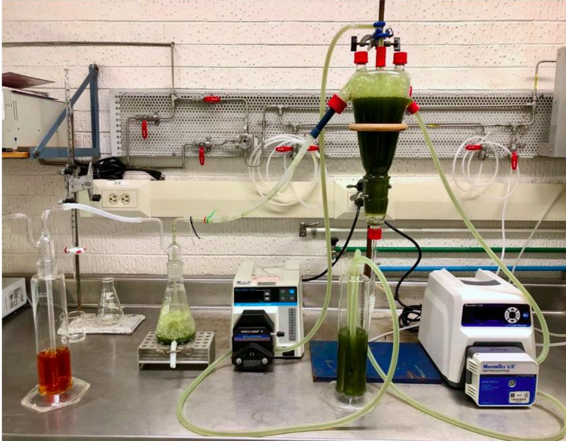
Figura 15. Fotografía del arreglo experimental implementado para las pruebas de ozono-flotación por lote
