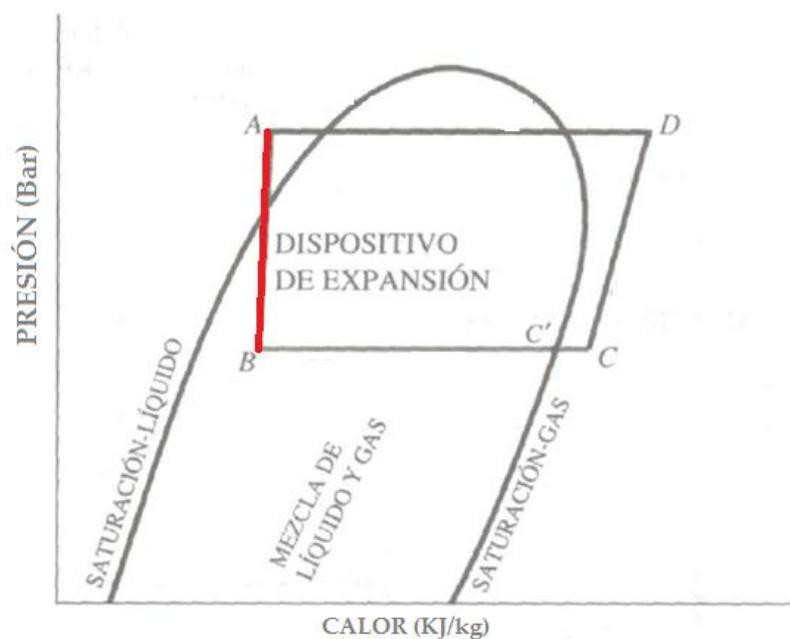
Gráfica 2.6 Proceso de un dispositivo de expansión en Presión - Entalpía
