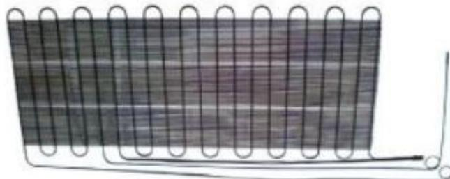
Ilustración 5.4 Absorbedor tipo serpentín J. Retek
