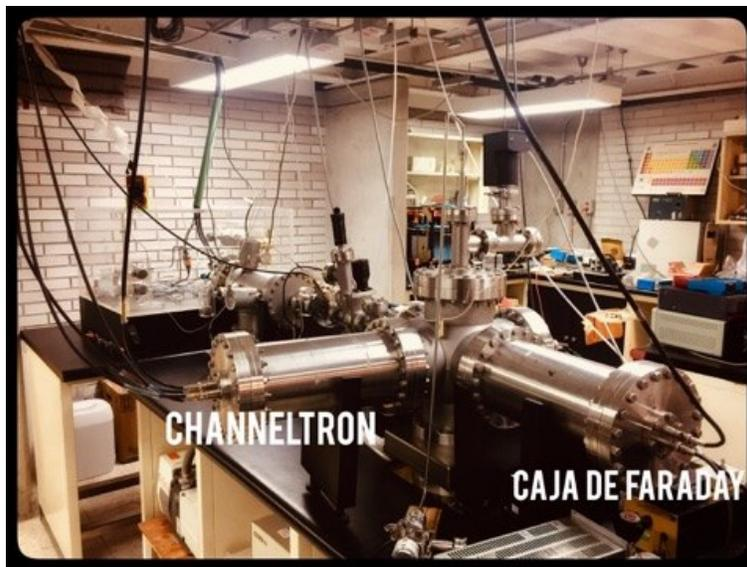
Figura 3.7: Foto de la zona de reacción y detección del acelerador de la Facultad de Ciencias U.N.A.M.
