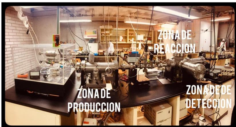
Figura 3.1: Partes principales que conforman el acelerador que se encuentra en la Facultad de Ciencias de la U.N.A.M.
