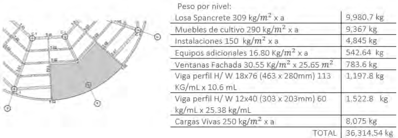
Figura 111. Tablero de carga 2.
