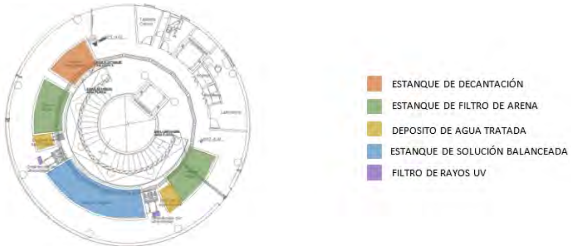
Figura 75. Sistema de tratamiento de agua / Planta Sótano
