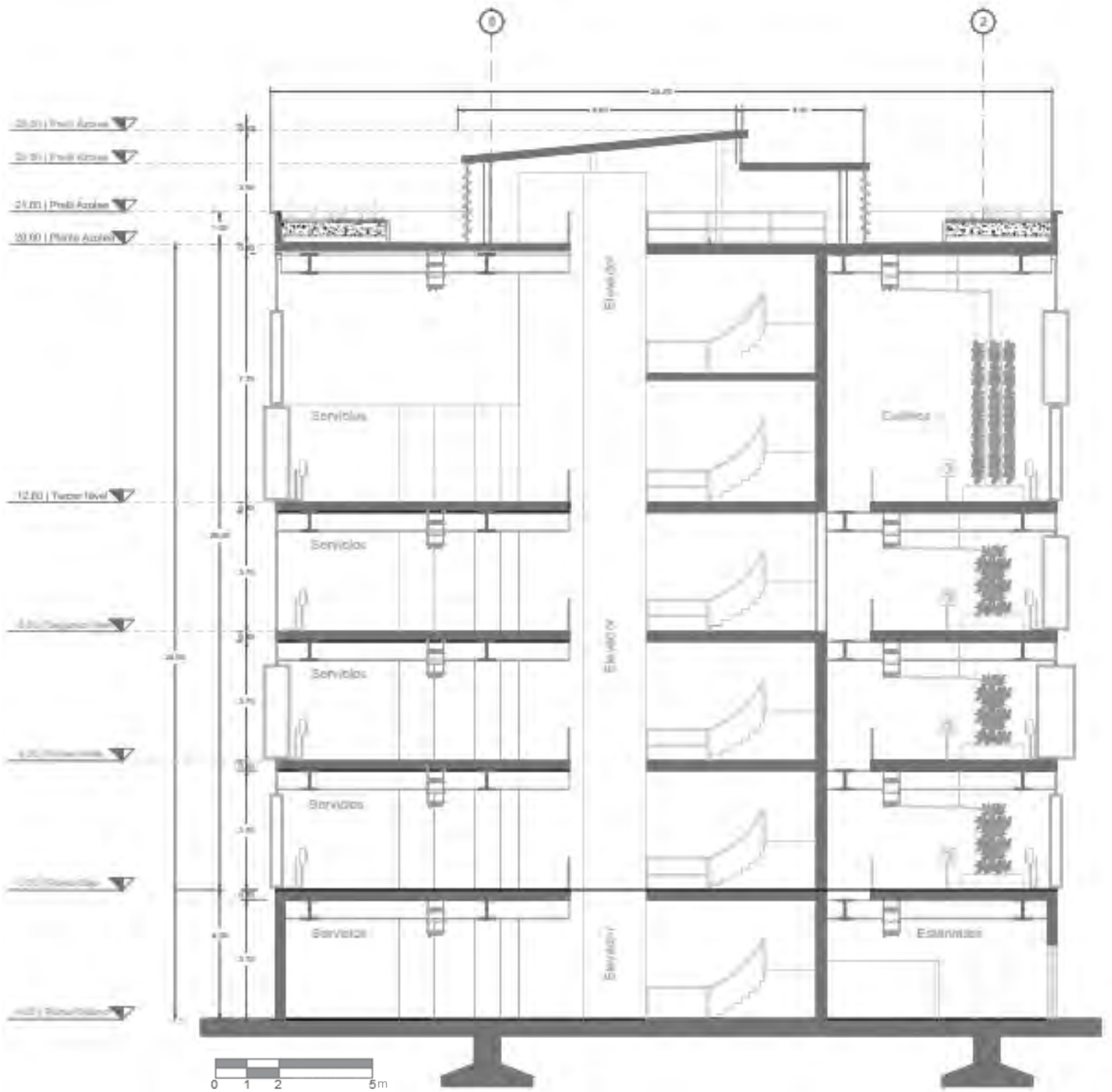
Figura 61. Corte Arquitectónico de la Torre de Cultivos.
