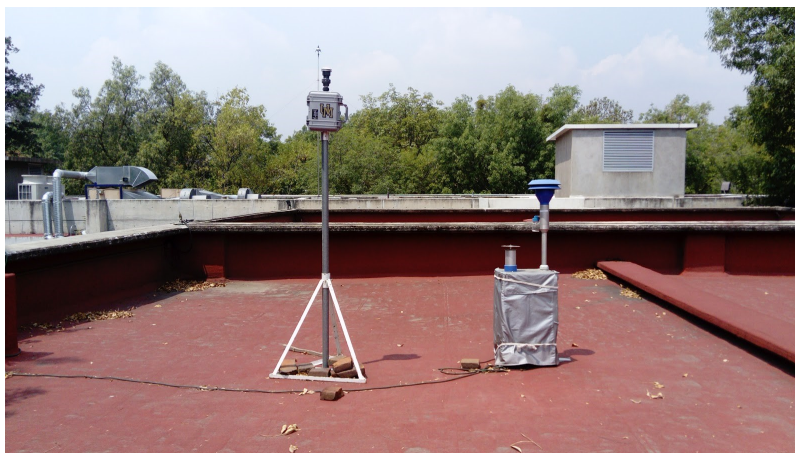
Figura 5.2: Muestreadores utilizados durante la campaña. 1.- Minivol TAS (izquierda), 2.- Ecotech AAS 27Mini (derecha).
