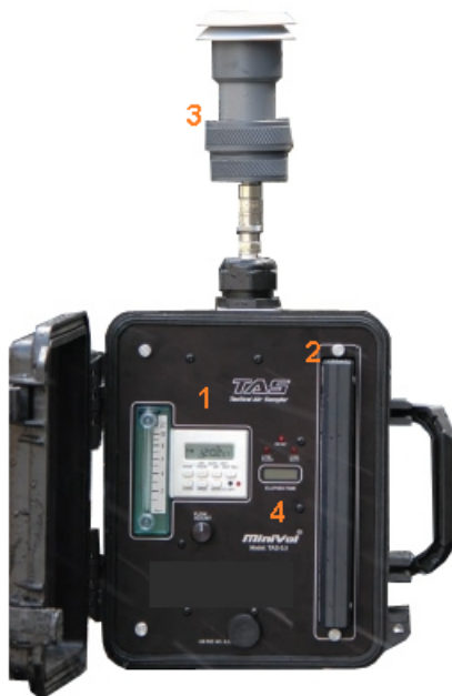
Figura 2.2: Muestreador MiniVol TAS. 1-Temporizador programable y flujoímetro, 2-Pila, 3-Cabezal, 4-Contador de tiempo de muestreo. En la parte posterior del equipo (dentro de la caja) se encuentra la bomba [Siafa, 2019].
