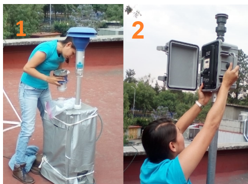
Figura 5.3: Proceso de recolección de las muestras durante la campaña de muestreo. 1.- Cambio de filtro \text{PM}_{10} en el Ecotech, 2.- Cambio de filtro \text{PM}_{10} para el MiniVol.
