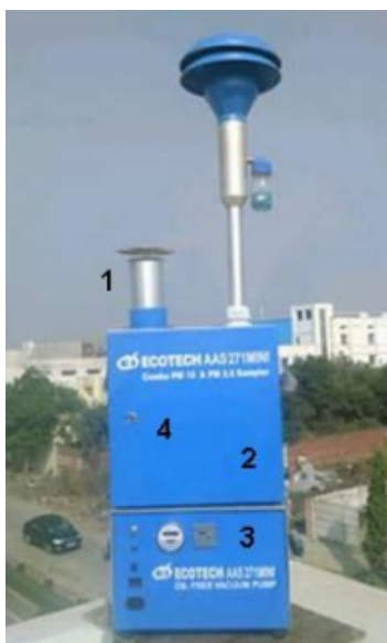
Figura 2.1: Muestreador Ecotech. 1-Impactor PM_{10} , 2-Impactor PM_{2.5} , 3-Temporizador digital programable junto con la bomba, 4- Flujómetros para PM_{10} y PM_{2.5} [Ecotech, SN].
