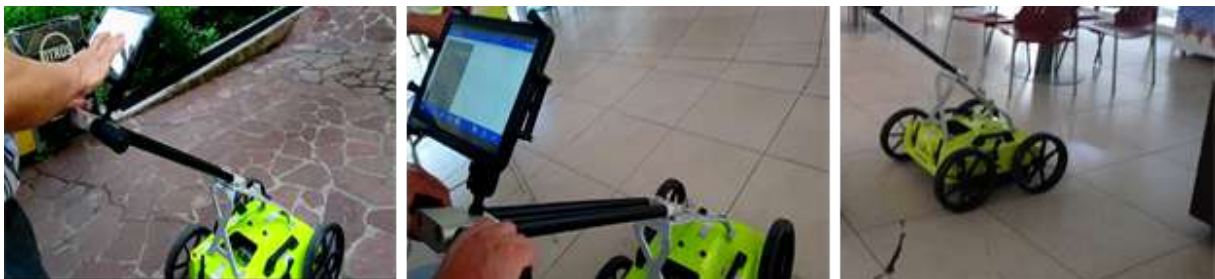
Ilustración 59, 60, 61. Equipo Georadar de Penetración Estándar
