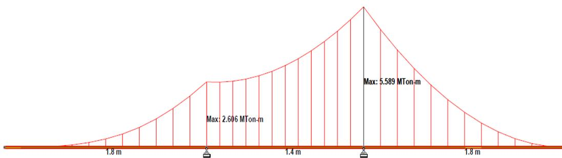
Figura IV.20 Diagrama de momentos actuantes en muro Milán.
