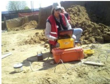
Figura II.14 Prueba de vibración ambiental (Aguilar, 2020).
