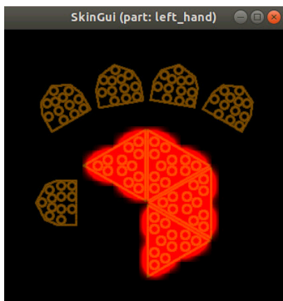
Figura 5.13: Sensores de tacto de la palma de la mano activados (en rojo) por el contacto con un objeto
