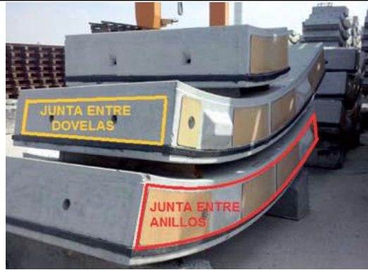
Figura 1-5. Dovelas con sus juntas elastoméricas (Peña y Basurto, 2014).
