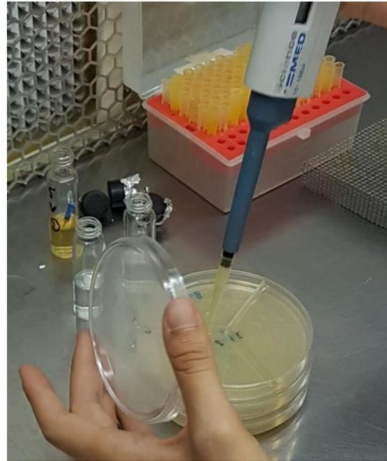
Fig. 33. Colocación de los 50  $\mu$ L en la caja de Petri septada con medio de cultivo en agar.
