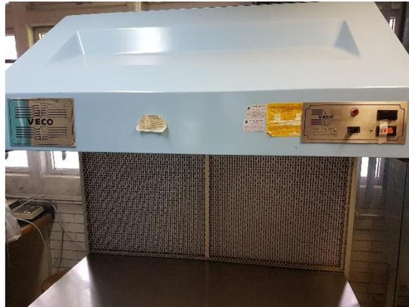
Fig. 14. Campana de flujo laminar: Recinto que emplea un ventilador para forzar el paso de aire a través de un filtro HEPA o ULPA y proporcionar aire limpio a la zona de trabajo libre de partículas de hasta 0.1 micras.
