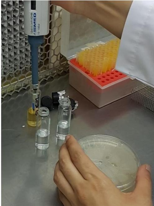
Fig. 32. Toma de 50  $\mu$ L del frasco vial de la muestra cultivada con micropipeta y punta estéril.
