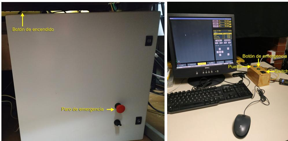
Figura A.1.2 Fotografías de la gaveta de la electrónica del sistema de posicionamiento y la zona de control en que se especifica la ubicación de los botones.
