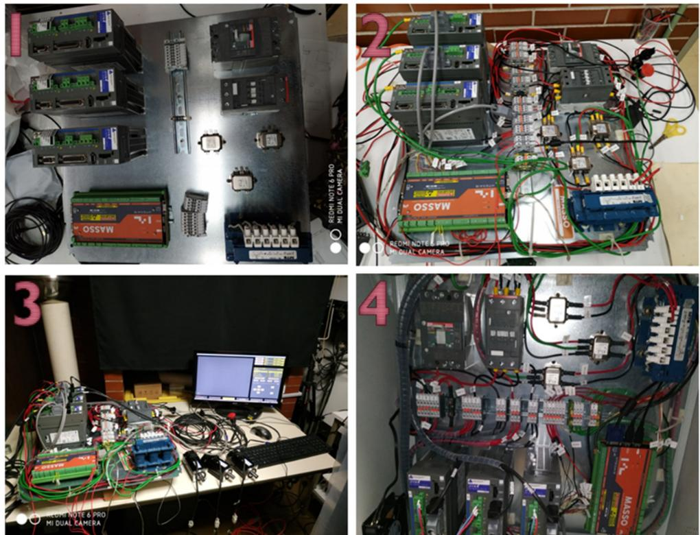
Figura 3.1.1 Fotografías de las distintas etapas de la construcción del sistema eléctrico y electrónico para la alimentación y protección del sistema de posicionamiento de tres ejes
