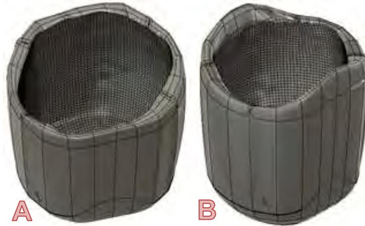
Fig. 70 a) Malla cerrada. b) Malla de socket terminada.
