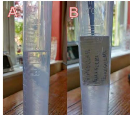
Fig. 47 A) Cilindro graduado 100 ml. B) Desplazamiento de agua
