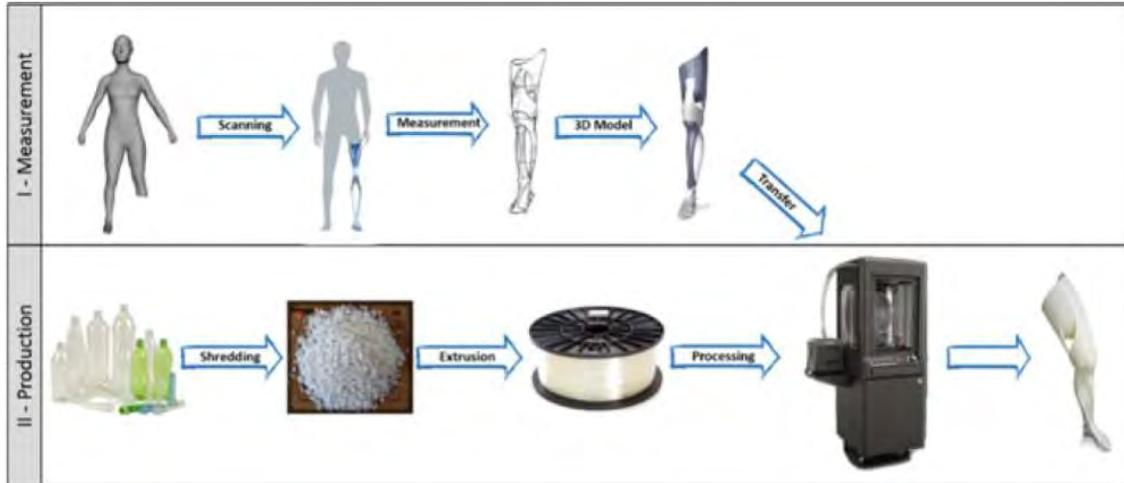
Fig. 6 Escaneo y proceso de producción. [2]
