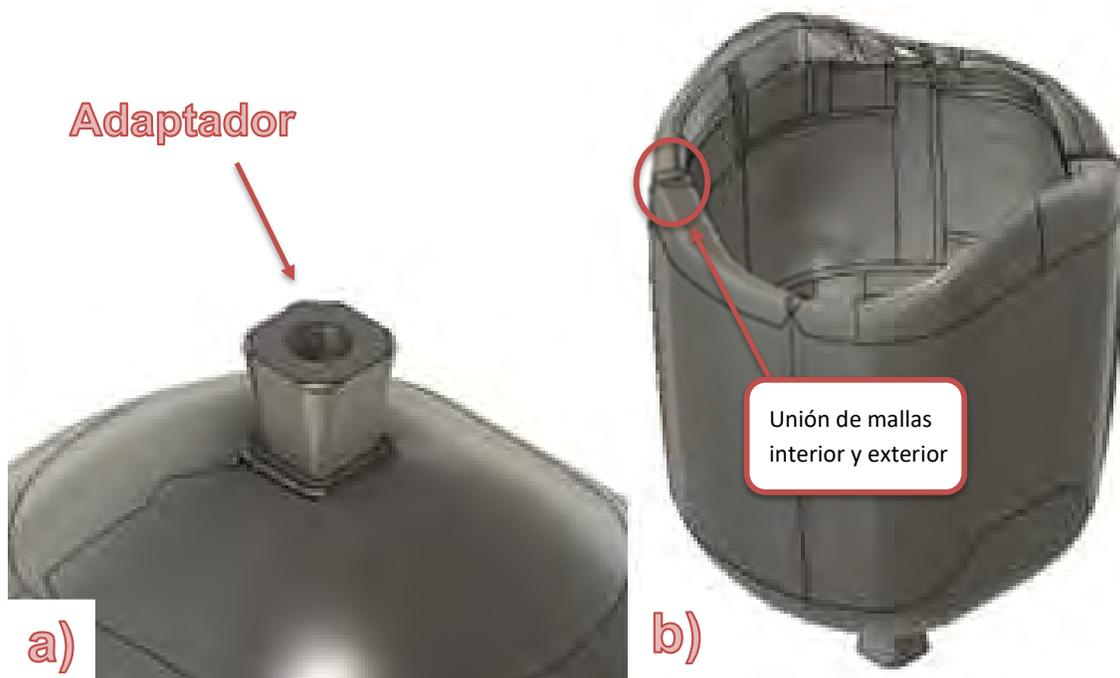
Fig. 71 a) Adaptador del socket. b) Modelo del socket.
