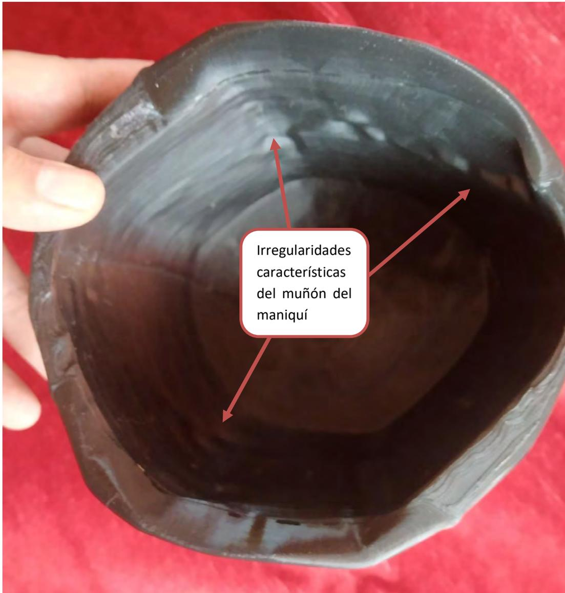
*Fig. 81 Interior del socket protésico*
