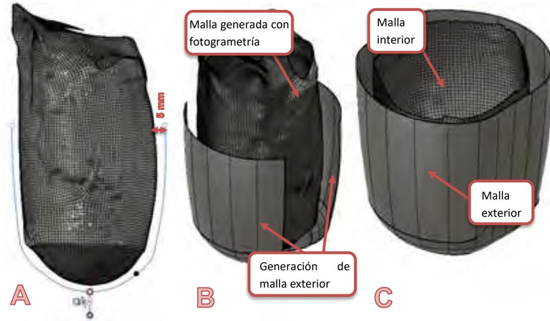
Fig. 68 Creación de malla externa
