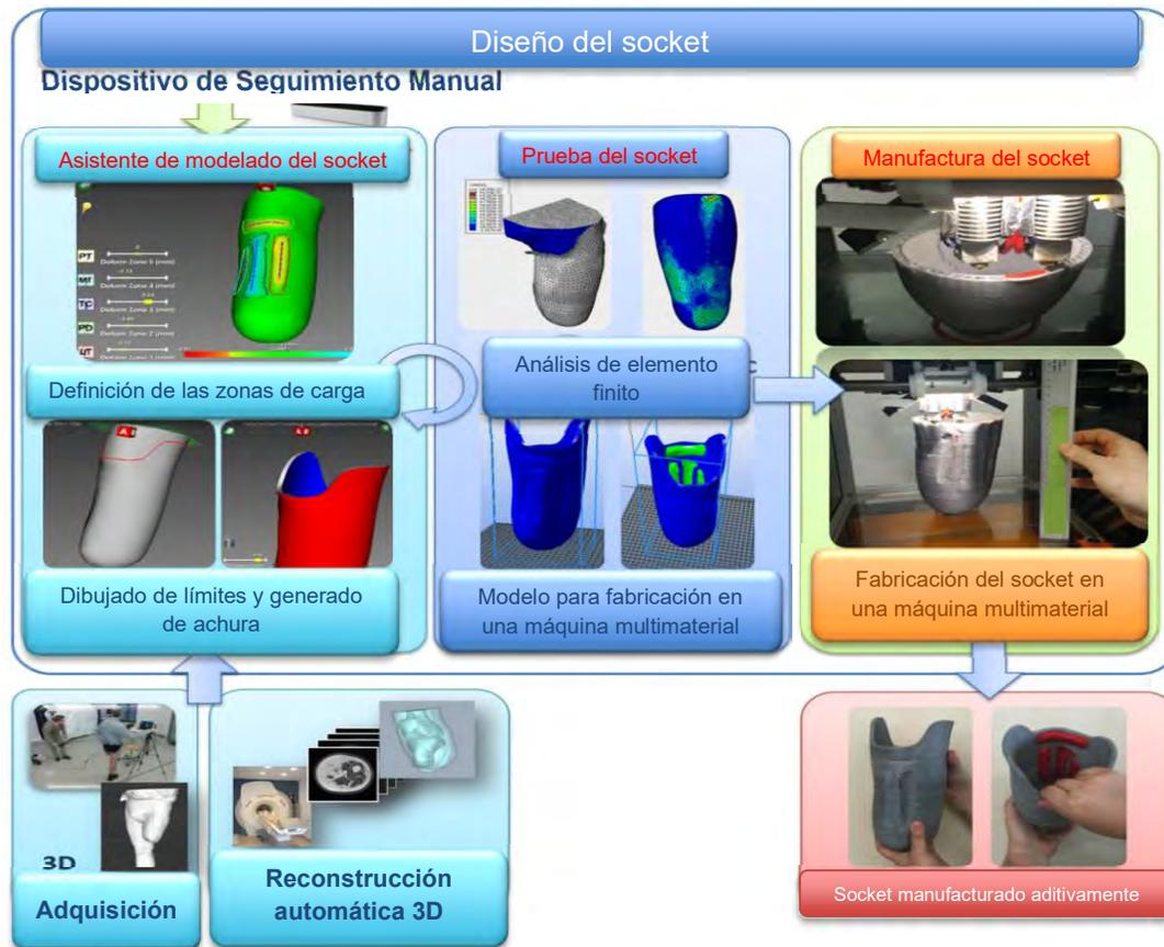
Fig. 13 Fases principales del método propuesto. [7]
