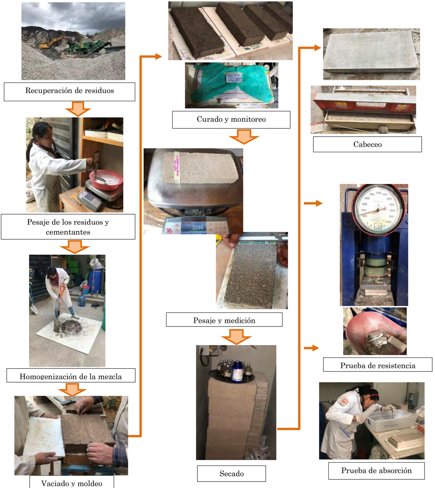
Figura 20.- Proceso constructivo para la fabricación de los especímenes
