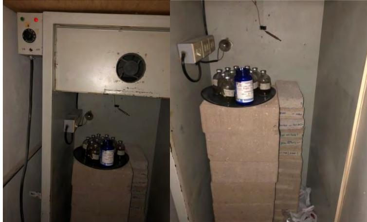
Figura 39.- Secado de los tabicones para la prueba de absorción
