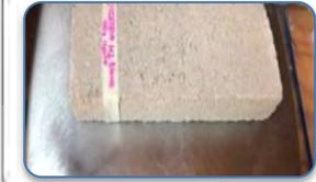
Se metió el tabicón en el horno de secado, hasta que después de dos pesadas la diferencia no era mayor de 0.2% de la masa de la pieza. Se obtuvo el peso del espécimen seco y estabilizado.
