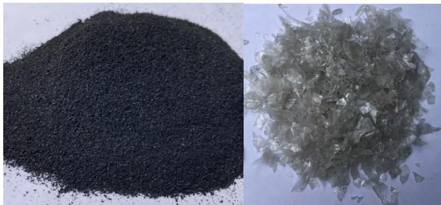
Figura 31.- Triturado de llanta y hojuela de PET
