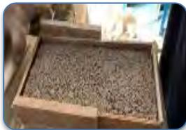
Se vació la mezcla elaborada sobre el molde que se colocó en la cara cuidando que el nivel de la mezcla permaneciera en el espesor del molde, se dejó secar y se realizó el procedimiento para ambas caras.
