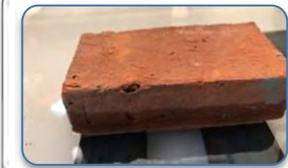
Se agregó agua potable al recipiente y se mantuvo con un depósito que regulaba el nivel, se colocó una pieza de referencia (ladrillo rojo saturado, con marca de 5 mm) para verificar las condiciones y nivel de agua.
