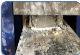
Cuando secaron los tabicones se colocaron en el centro de la superficie del equipo de compresión, se colocó una placa como lo marca la norma para alcanzar la altura, para finalizar se aplicó la carga, cuando el espécimen sufrió fisuras se dio por terminada la prueba y se registró el dato para cada uno.
