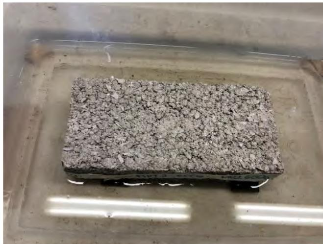
Figura 40.- Prueba de absorción en tabicones
