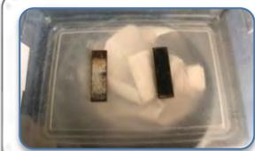
Se preparó un recipiente rectangular con un área no menor  $1936 \text{ cm}^2$  y con una profundidad de 1.3 cm, se colocaron dos barras de metal inoxidable de longitud entre 12.7 cm y 15.3 cm cuya altura debía de ser de 6 mm.
