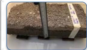
Se colocó una cara del tabicón en el recipiente preparado con anterioridad y sobre las placas metálicas, ya que se encontraba en posición se tomó el tiempo (10 min).
