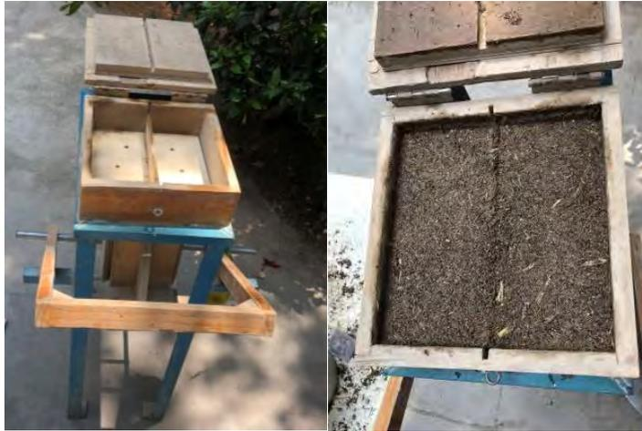
Figura 19.- Máquina moldeadora de ladrillo
