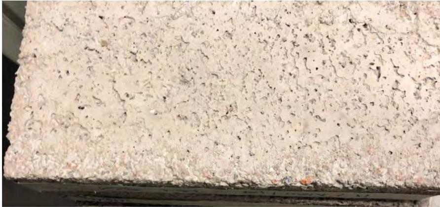
Figura 35.- Tabicones de RCD y PET
