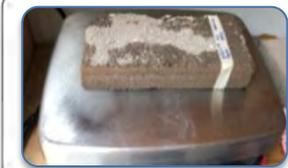
Pasado el tiempo se retiró del agua el tabicón, se quitó el exceso de agua por 15 segundos con un trapo y posterior se realizó el pesaje. Posterior se determinó mediante ecuaciones el resultado.
