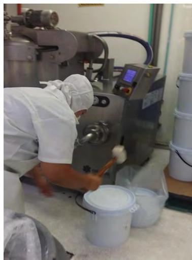
*Fotografías: Colocación manual de tapas.*
