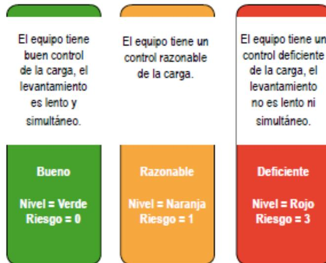
Figura A33. Flujoograma para la evaluación de tareas de levantamiento y descenso en equipo.
