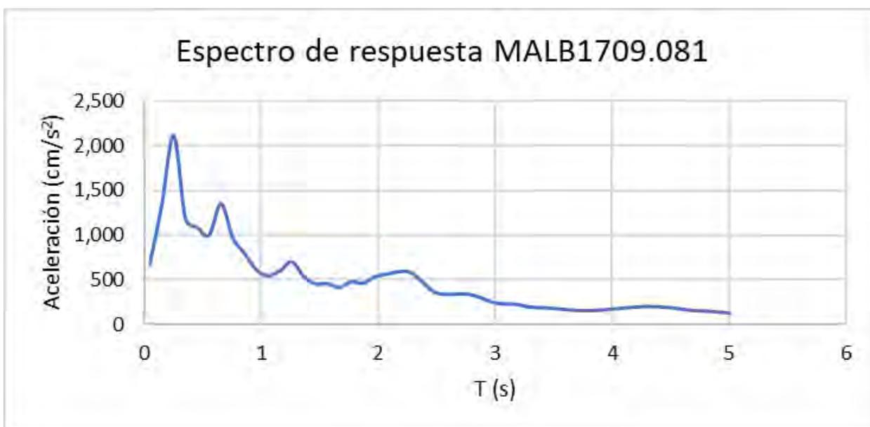
Fig. 4.4. Espectro de respuesta de aceleración para el archivo del sismo MALB1709.081
