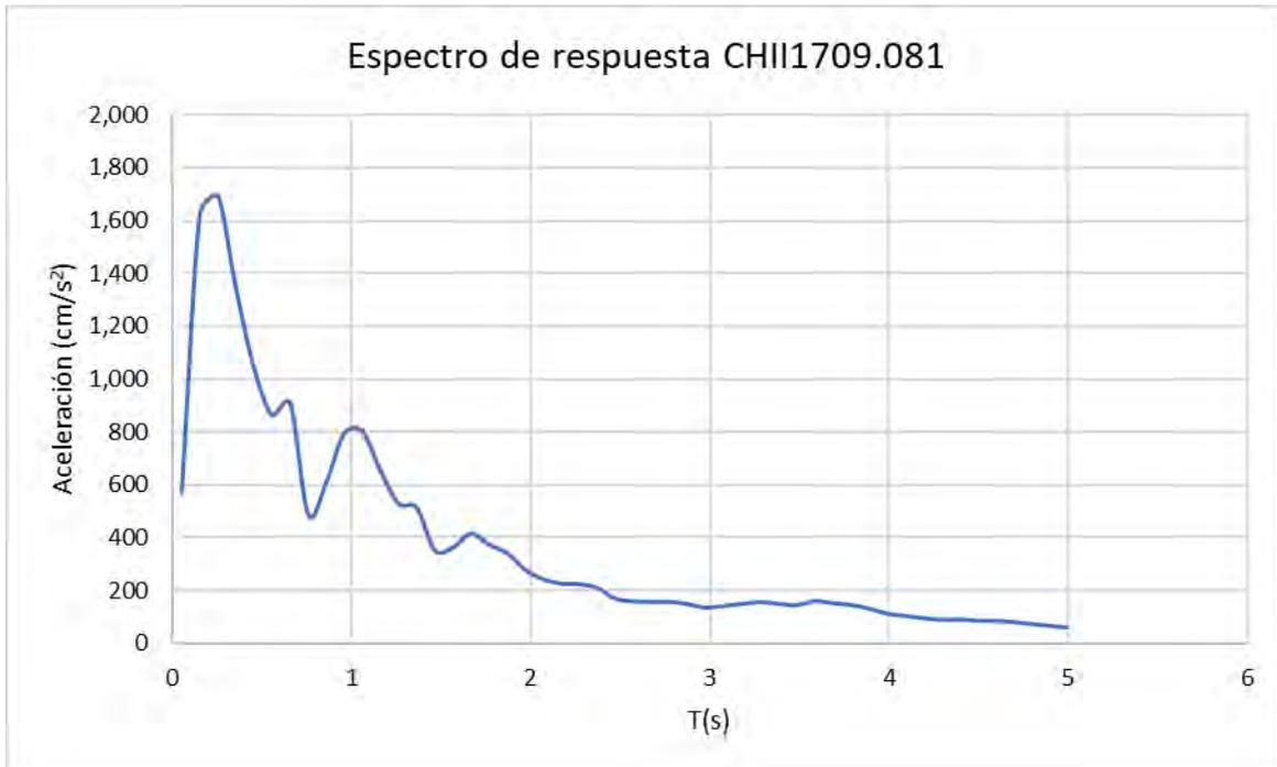
Fig. 4.20. Espectro de respuesta de aceleración para el archivo del sismo CHII1709.081
