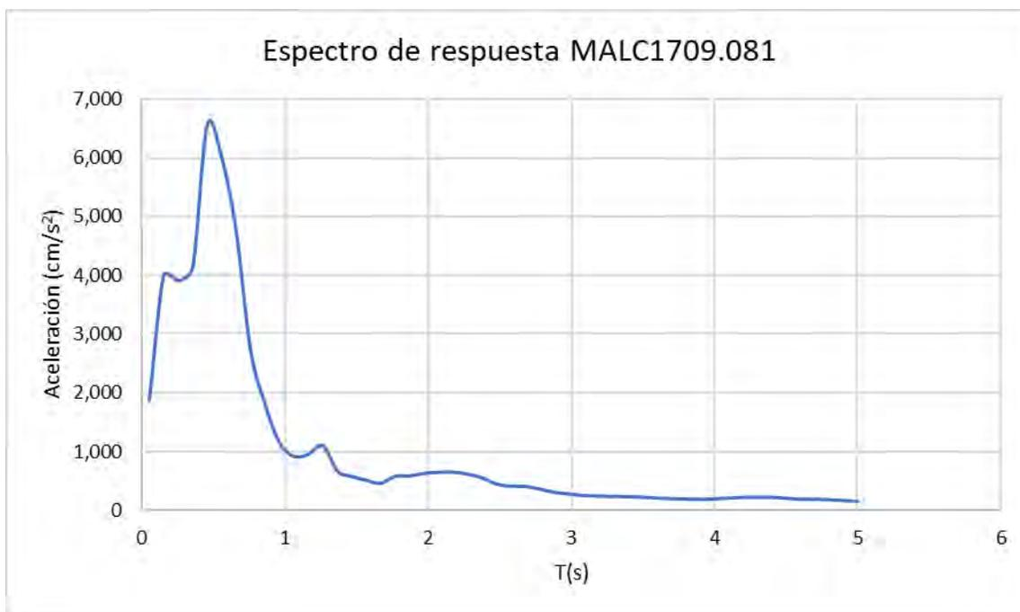
Fig. 4.6. Espectro de respuesta de aceleración para el archivo del sismo MALB1709.081
