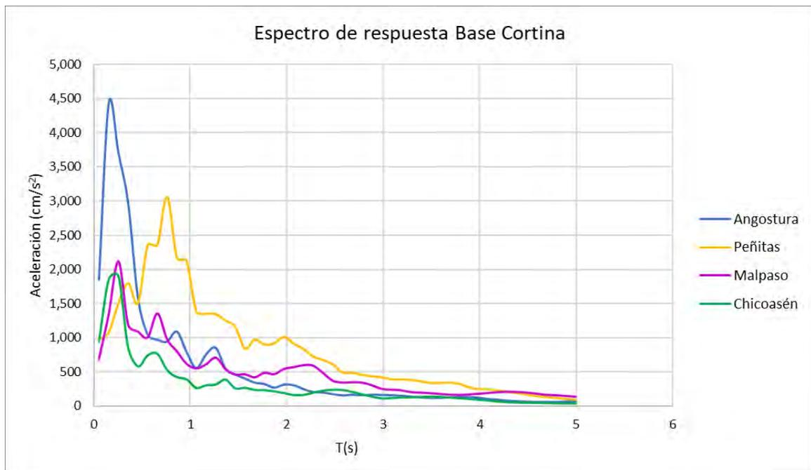
Fig. 4.29. Espectros de respuesta sobre la base de la cortina de las cuatro presas
