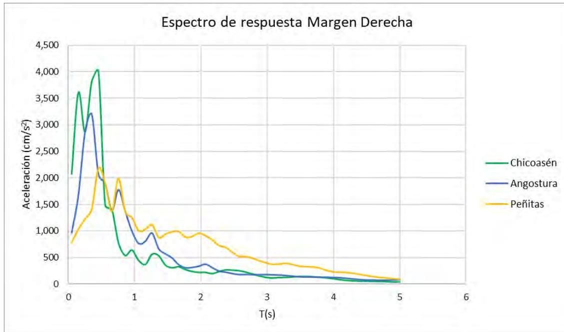
Fig. 4.31. Aceleración de la Margen derecha para tres presas.
