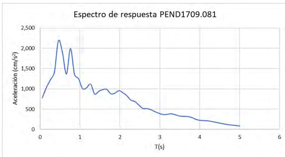
Fig. 4.26. Espectro de respuesta de aceleración para el archivo del sismo PEND1709.081
