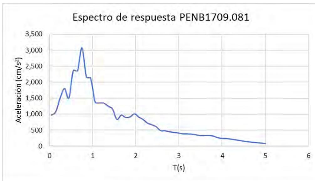
Fig. 4.22. Espectro de respuesta de aceleración para el archivo del sismo PENB1709.081
