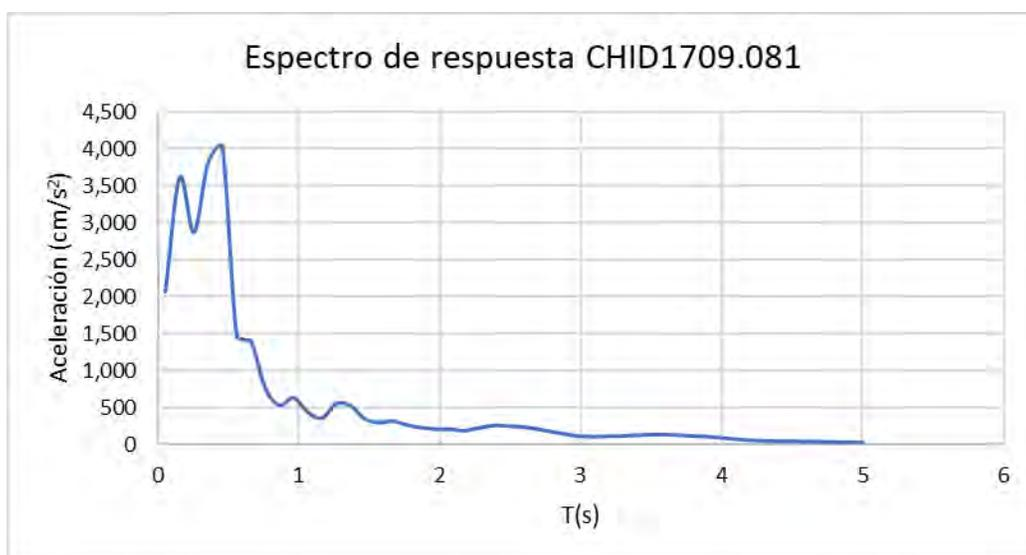
Fig. 4.18. Espectro de respuesta de aceleración para el archivo del sismo CHID1709.081
