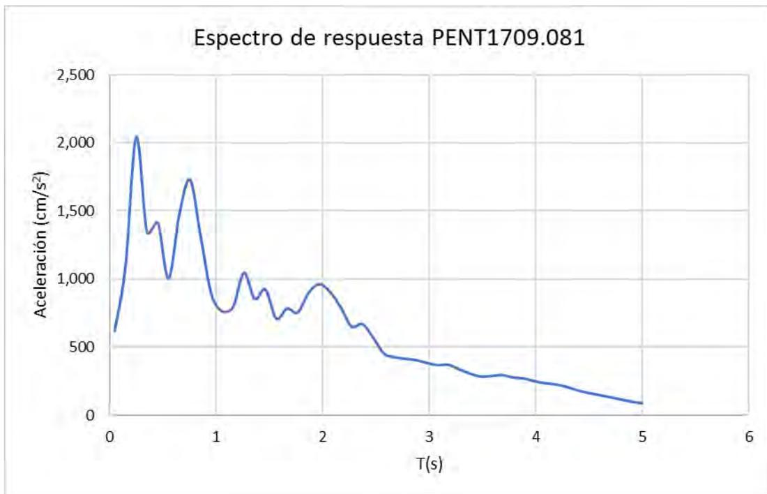
Fig. 4.28. Espectro de respuesta de aceleración para el archivo del sismo PENT1709.081
