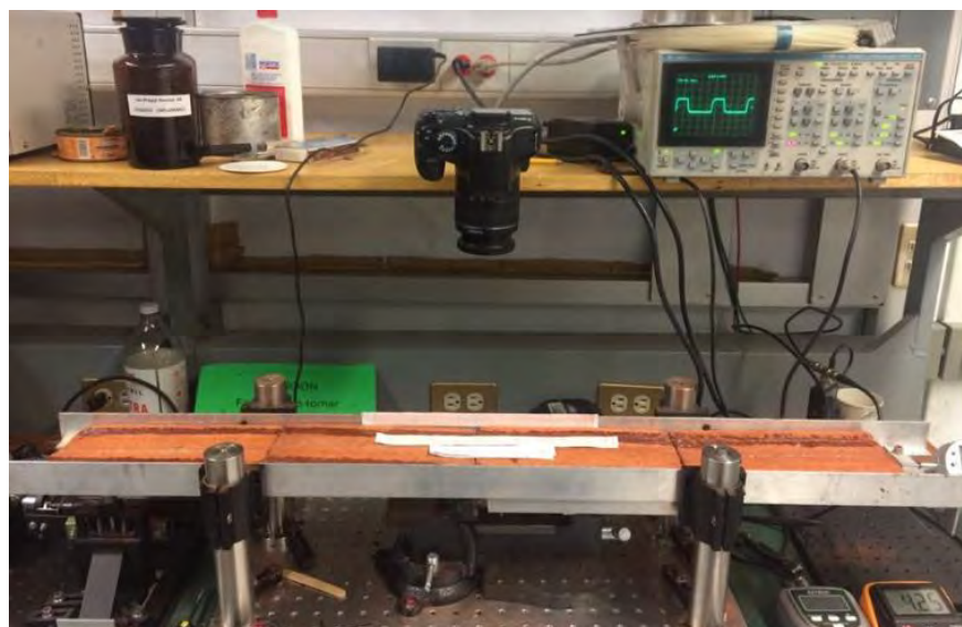
Figura 3.1 Instalación de tracción con elementos de mampostería.
