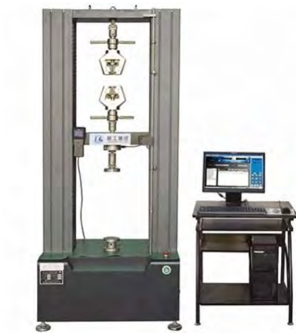
Figura 2.4 universal CMT-50 Control de computadora máquina universal de ensayos Electrónica/Universal tracción compresión máquina de prueba
