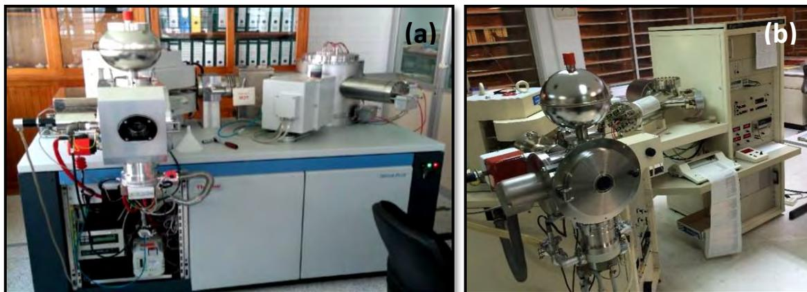
Figura 3.6. (a) Espectrómetro TIMS THERMO SCIENTIFIC TRITON PLUS en el cual se midió el Sr y Nd de las muestras. (b) Espectrómetro de Ionización Térmica FINNIGAN MAT 262 en el cual se midió el Pb de las muestras. Ambos equipos pertenecen al LUGIS del Instituto de Geofísica.
