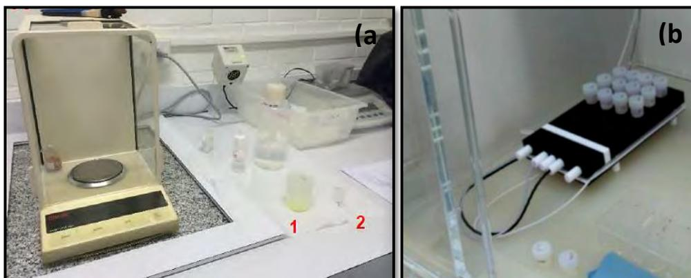
Figura 3.7. (a) Balanza analítica de 5 dígitos para obtener el peso preciso de las bombas antes de la digestión (1: vaso para REE; 2: vaso para Sr-Rb). (b) Parrilla de calentamiento de las bombas para evaporar los ácidos agregados junto con elementos no deseados en la muestra.
