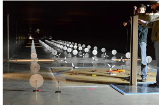
b) Experimento en laboratorio con turbinas de viento y discos porosos (Kroll et al. , 2015).
