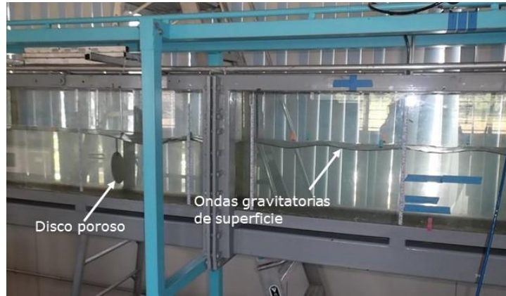
Ilustración 5.6. Ondas gravitatorias de superficie utilizando un disco poroso D_3 = 136 mm (Martínez-Reyes & García-Villanueva, 2020).
