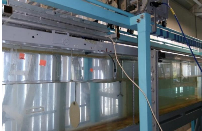
Ilustración 5.1. Canal experimental de sección rectangular (Martínez-Reyes & García-Villanueva, 2020).
