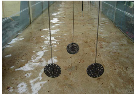
Ilustración 3.12. Discos de actuadores utilizados para simular matrices de turbinas (Myers & Bahaj, 2012).
