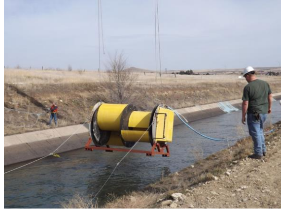
Ilustración 3.4. Prototipo de turbina hidrocínética desarrollada por Hydrovolts.
