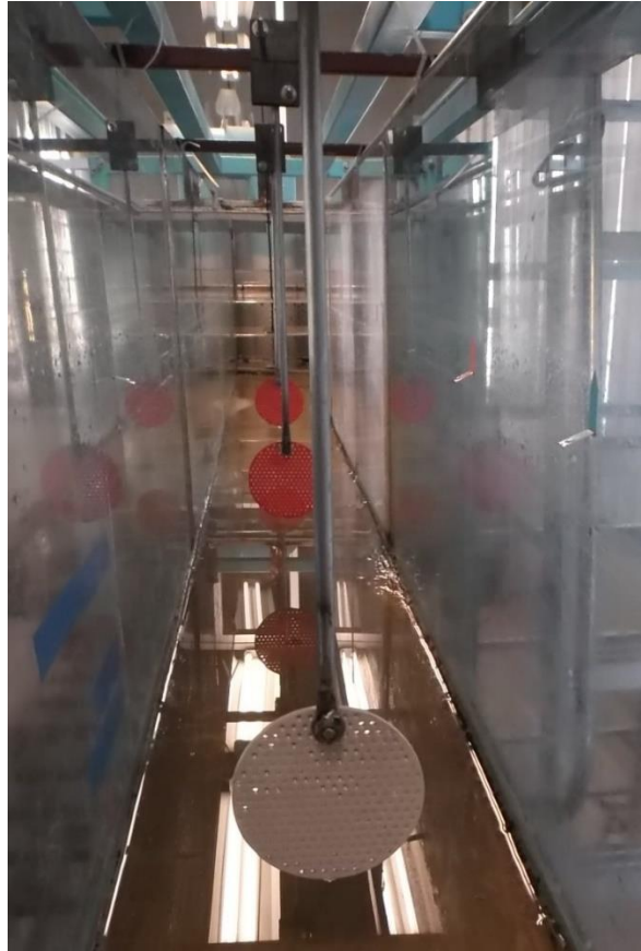
Ilustración 5.23. Discos porosos colocados en un arreglo en serie en el canal experimental.
