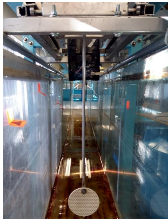
Ilustración 5.12. Instalación del dispositivo para medir el empuje hidrodinámico en los discos.
