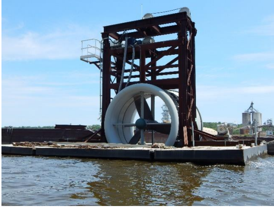
Ilustración 3.3. Turbina hidrocínética comercial instalada en el río Mississippi, E.U.A.
