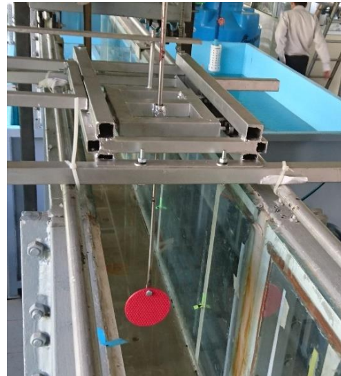
Ilustración 5.10. Etapa de construcción e instalación del dispositivo para medir empuje sobre el disco poroso.
