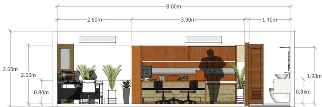
*Imagen. Alzado Arquitectónico con análisis de área.
