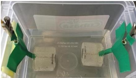
Figura 9. Muestras sumergidas en la disolución NaCl 3.5% en peso.
