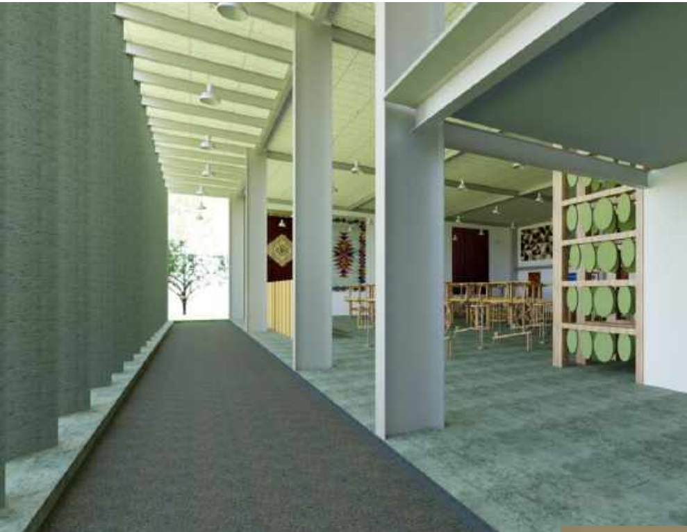
FIGURA 88. Vista del taller de pedal, se observan los parteluces de concreto que nos ayudaran a disminuir la entrada de luz. Elaboración propia.
