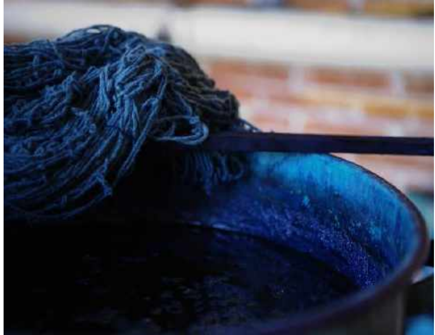
FIGURA 7. Teñido del índigo en ollas de acero inoxidable, en hornos de gas, foto tomada en el taller del maestro Román Gutiérrez. Teotitlán del Valle Oaxaca. Foto por: Lizbeth Gutiérrez Sosa. 2019.
