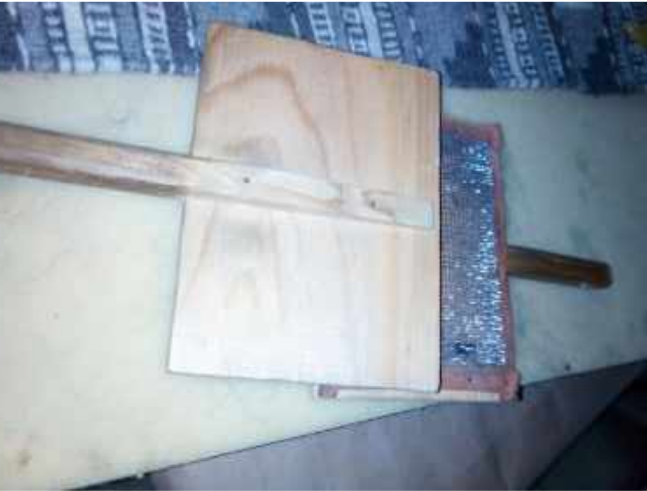
FIGURA 14. Cardadora de lana manual del taller del maestro Román Gutiérrez. Teotitlán del valle. Foto por: Lizbeth Gutiérrez Sosa. 2019
