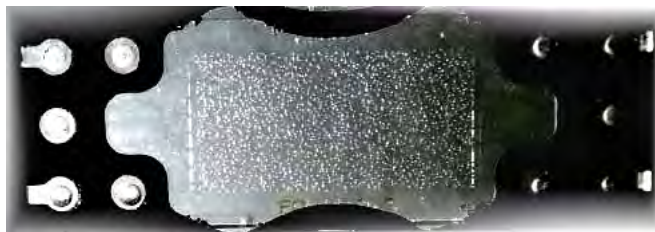
Figura 3.9: Micromodelo utilizado para la recuperación de crudo.
