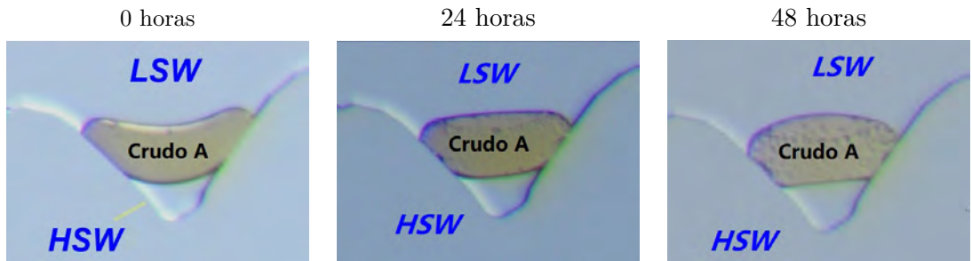
Figura 4.16: Sección analizada para medición de cambio de ángulo HSW depósito interno, LSW exterior. a. 0 horas. b. 24 horas c. 48 horas.
