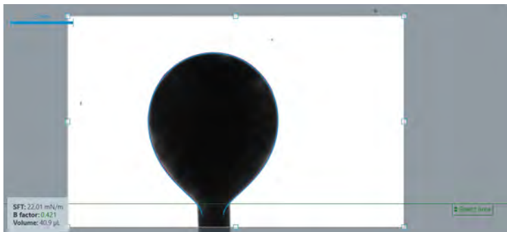
Figura 2.17: Gota colgante para medición de tensión interfacial: éste método consta de una aguja suspendida en una fase líquida o gaseosa. La forma de la gota resulta de la relación entre la tensión interfacial y la forma, esta tensión se calcula a partir de la sombra usando el análisis de forma de gota [imagen original].
