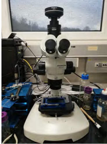
Figura 3.7: Microscopio estereoscópico OLYMPUS SZX7 , lente OLYMPUS ACH 1X y cámara OLYMPUS UC90 .
