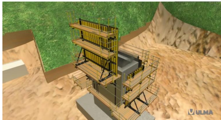
Fig. 29 ah. Izado y colocación del paño exterior armado con la plataforma de recuperación de conos.
