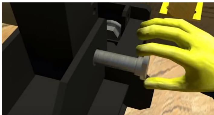
Fig. 29 v. Detalle de colocación de perno / pasador, entre el panel y la consola. Recuperado de: https://www.youtube.com/watch?v=8DesVSJeDJE
