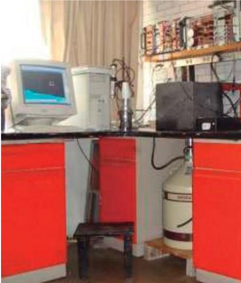
Figura 3-1 Fotografía del equipo de espectrometría gamma (PAD-IFUNAM)
