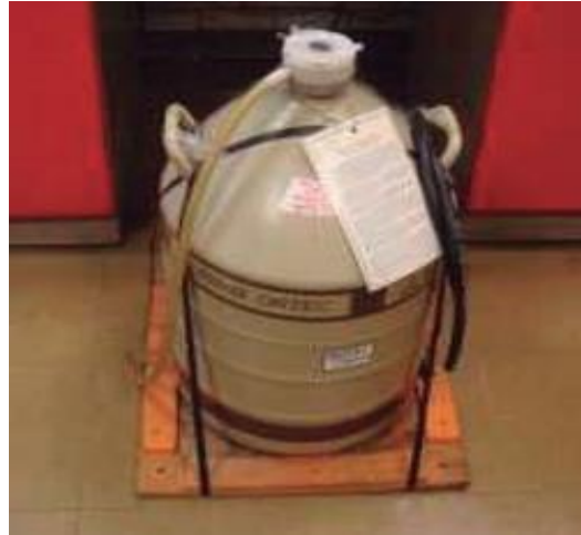
Figura 3-7 Fotografía del contenedor Dewar (PAD-IFUNAM)
