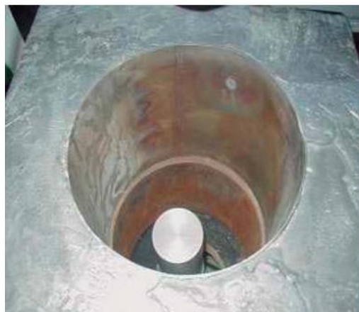
Figura 3-6 Fotografía del detector de Germanio Hiperpuro dentro del blindaje de plomo viejo (PAD-IFUNAM)
