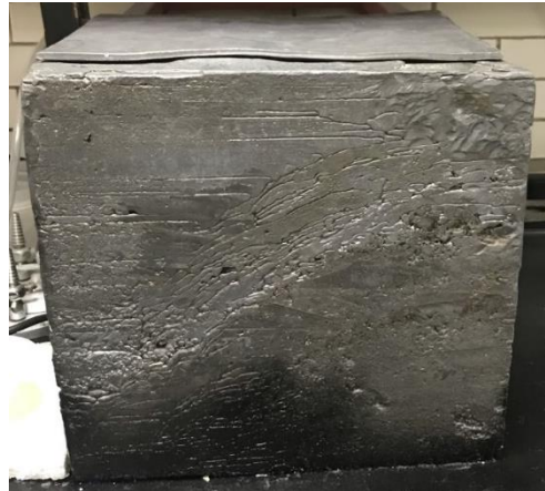
Figura 3-5 Fotografía del blindaje de plomo viejo del detector (PAD-IFUNAM),
