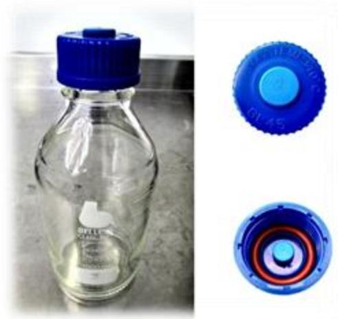
**Figura 6.** Botella de vidrio hermética equipada con septo de goma para la toma de muestras líquidas y gaseosas.
