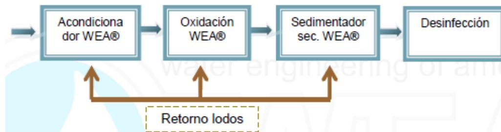
**Imagen 68 Diagrama de funcionamiento de Planta de Tratamiento**
