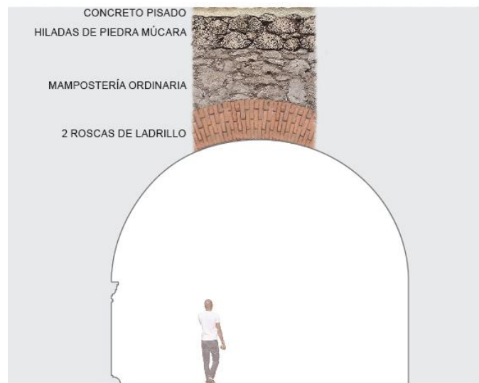
Figura 7. 42 Representación gráfica de la técnica constructiva aplicada en las bóvedas B-02, de acuerdo con los testimonios de un tiro de ventilación.
