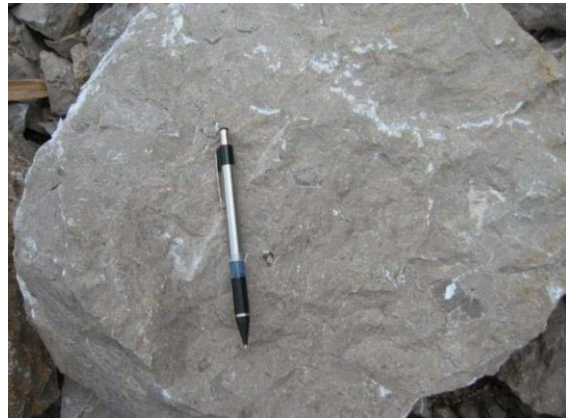
Figura 7. 3 Caliza fosilífera tipo Peñuela del cerro Cuauhtémoc
