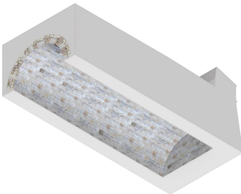
Figura 7. 84 Vista del intradós de la bóveda B-01.
