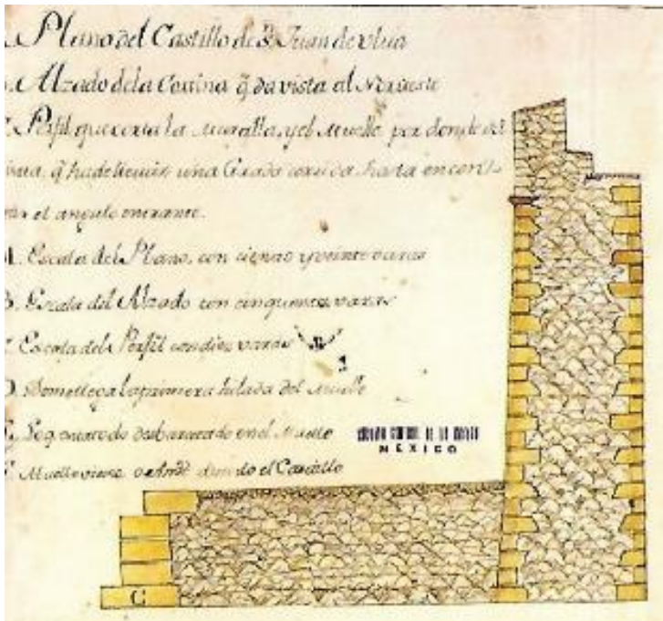
Figura 7. 15 Fragmento del plano del Castillo de San Juan de Ulúa (ca. 1760) en donde se observa el corte de la muralla y la representación del sistema constructivo a base de piedra muca. Imagen tomada del libro Fortalezas históricas de Veracruz, p. 79. Fuente original: Archivo General de la Nación México.
