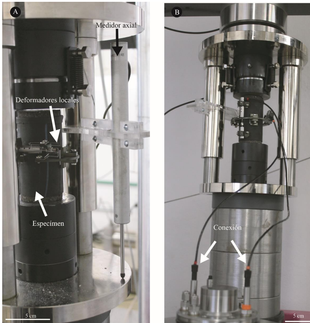
Figura 22 Montura y conexión de la celda de carga con los data loggers. A) Vista general de los deformadores locales y el medidor axial de la celda. B) Vista general de la conexión de los medidores a la base de la celda.
