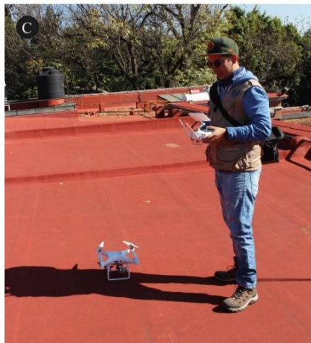
Figura 8 Empleo del dron para generar modelos georreferenciados 3D. A) Dron DJI Phantom 4Pro. B) Calibración del dron. C) Dron antes de elevarse a la altura deseada. D) Dron a 10 m de altura antes de colocar la cámara en posición “ortofoto”.
