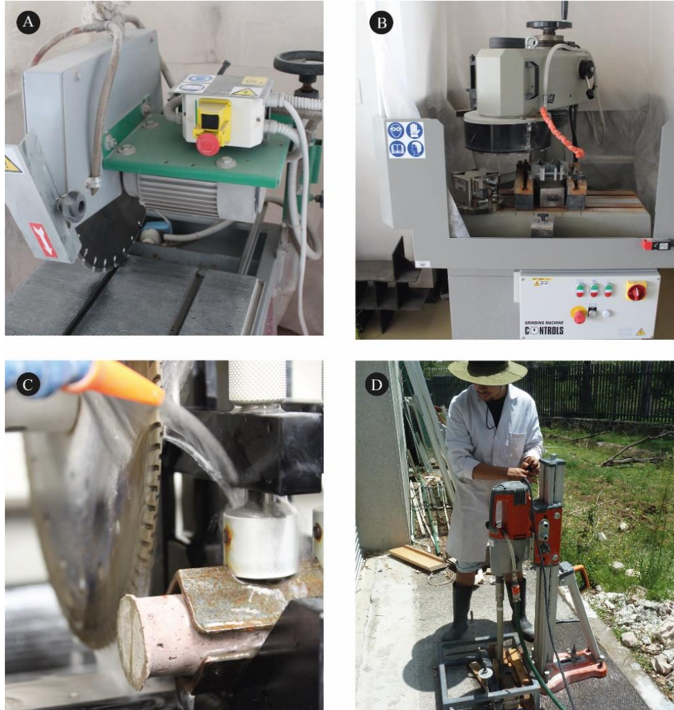
Figura 13 Equipos de corte y preparación de especímenes. A) Sierra de banco Controls modelo 55-C02010/DZ. B) Rectificadora marca Controls modelo 55-C0201/3. C) Cortadora de testigos y esmeriladora Controls modelo 45-D0536/AZ. D) extractora de núcleos Controls modelo C0330/Z.
