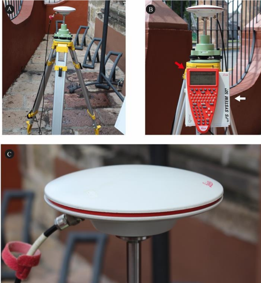
Figura 9 Equipo de medición GPS. A) Tripié con base de GPS para obtener la nivelación. B) GPS System 500, la flecha roja destaca la terminal y la flecha blanca el receptor GPS. C) Antena GPS donde se destaca el cable de conexión que va hacia el receptor.
