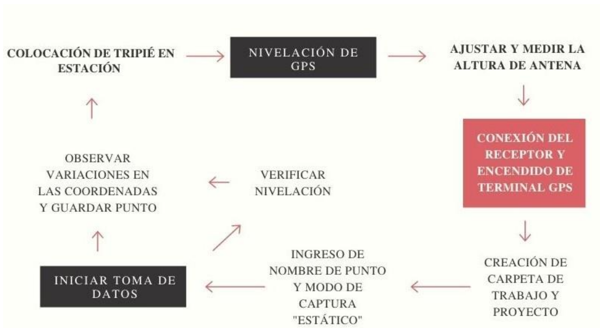
Figura 12 Diagrama de flujo que muestra el proceso de adquisición de datos con el GPS Leica system 500
