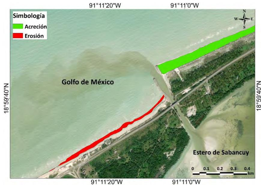
Figura 15. Detalle de las áreas de acreción y erosión en la zona del canal de acceso.
