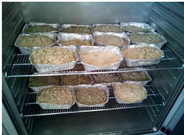
Figura 9. Secado de muestras de sedimento en hornos de convección.
