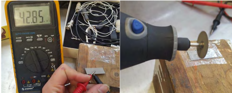
a) Transductor piezocerámico 303. b) Herramienta y disco de corte empleados Capacitancia: 42.85 nF
