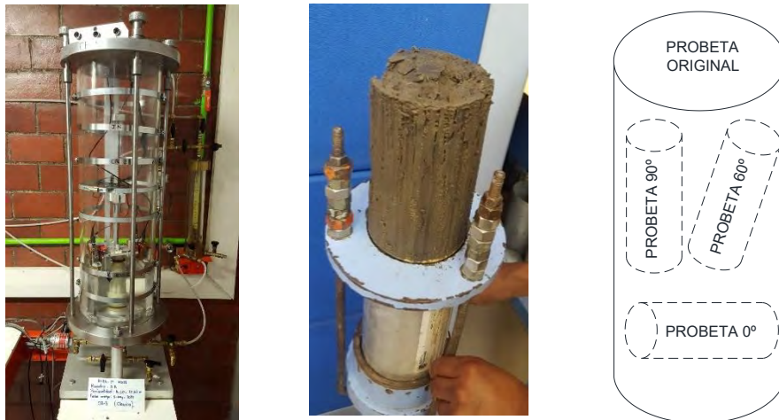
Figura 41. Ensayo de Columna Resonante (izquierda). Extracción de la muestra (centro). Esquema de corte (derecha).
