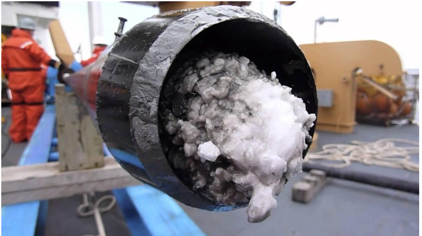
Figura 1.3.12 Tapón de hidratos de gas en un pistón muestrero para tomar núcleos (PolarTREC, 2010).
