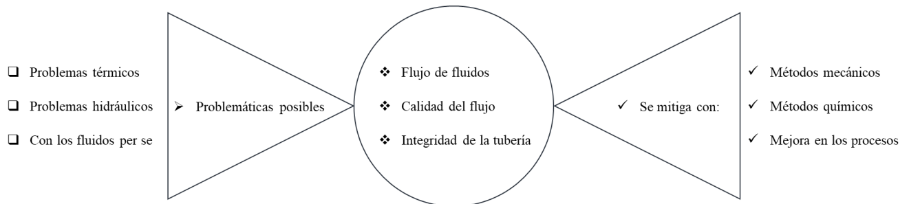
Figura 1.2.1 Esquema de análisis de riesgo de tipo moño para el aseguramiento de flujo (Makogon, 2019).
