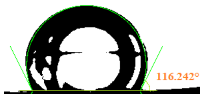
Figura 3.17: Figura que muestra una de las mediciones de ángulo de contacto, en andamio PCL/gelatina.
