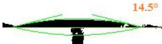
Figura 3.39: Figura que muestra una de las mediciones de ángulo de contacto, en andamio de PCL/gelatina de fibras alineadas.
