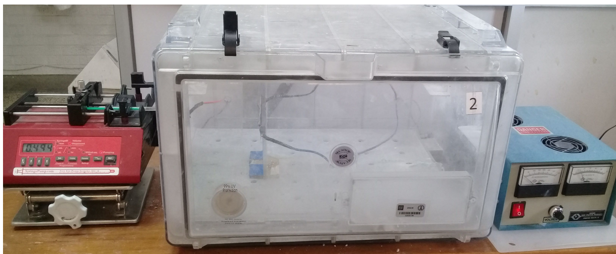
Figura 2.1: Arreglo experimental convencional del proceso de electrohilado para obtener andamios electrohilados de fibras de orientación aleatoria. En la imagen se observa en el extremo derecho, la fuente de alto voltaje, que se aplica entre la punta de la jeringa y el colector, para formar las nanofibras poliméricas; en el centro se observa una caja de poli(metil-metacrilato) que contiene en su interior el colector (donde impactan las nanofibras), las conexiones (cables y caimanos) para aplicar el alto voltaje entre la aguja y el colector y sílica para mantener constante la humedad; en el extremo izquierdo se observa la bomba que dosifica la solución polimérica, y es sobre la que se encuentra la jeringa, cuya aguja entra en la caja de acrílico a través de una pequeña perforación.
