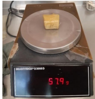
Figura E.4. Muestra de suelo cubierta de cera.
