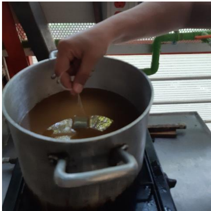
Figura E.3. Encerado de la muestra de suelo.
