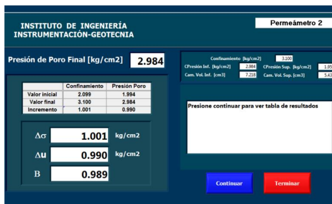
Figura 3.6. Medición del parámetro B de Skempton.
