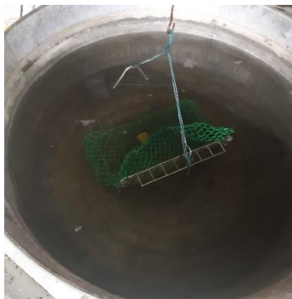
Figura E.5. Determinación del peso sumergido.
