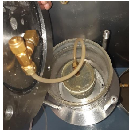
Figura D.4. Conexión del dren superior.
