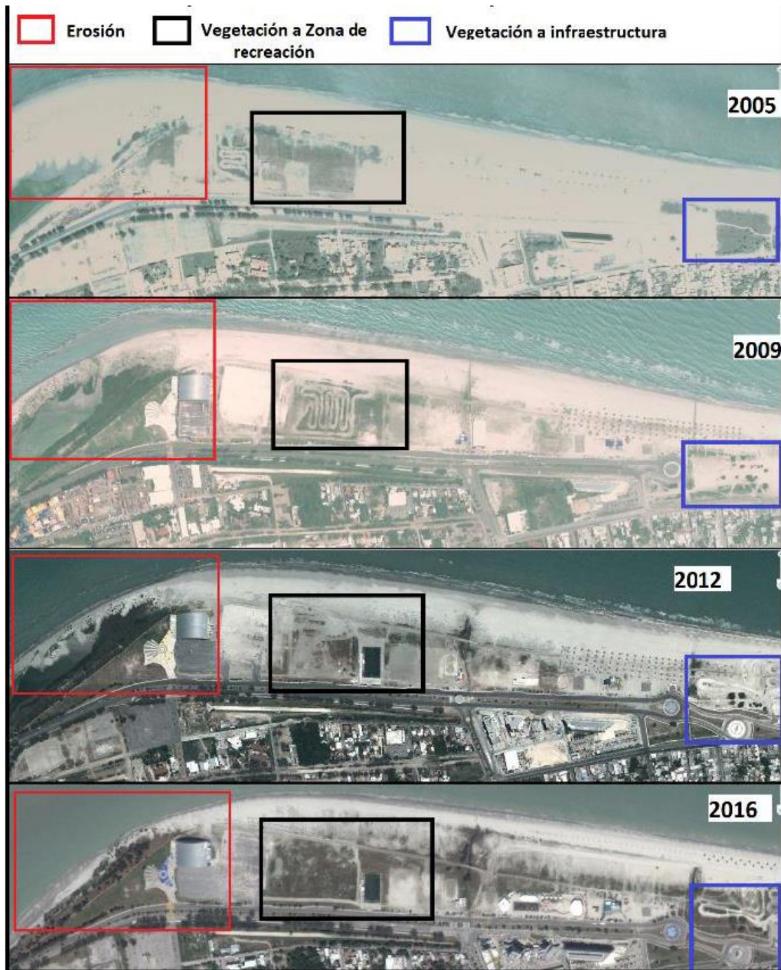
Figura 30. Erosión en Playa Norte: en rojo área expuesta a erosión, en negro y azul cambio de vegetación a zona de recreación e infraestructura.
