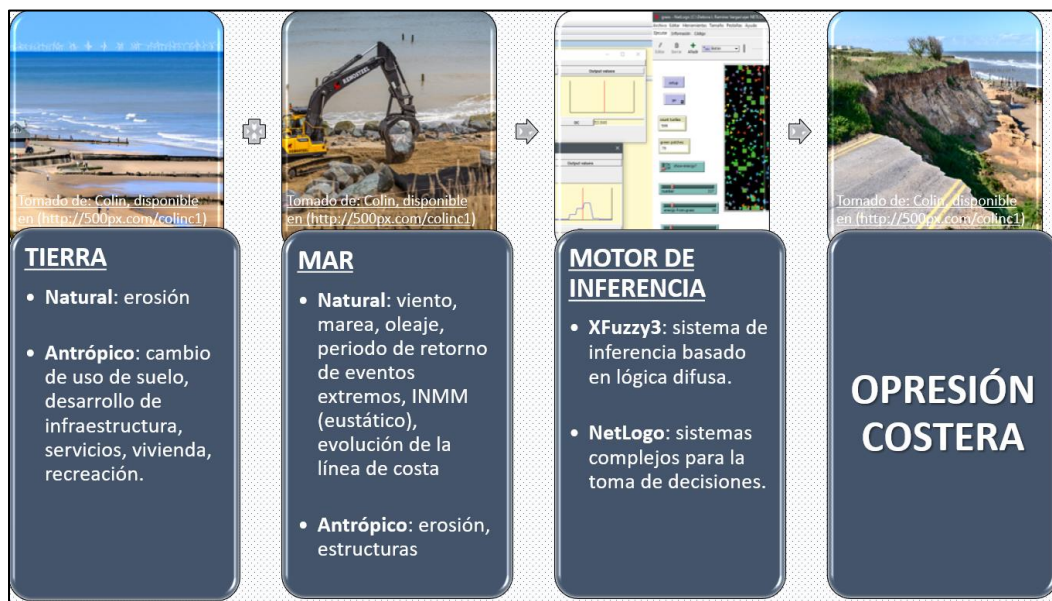
Figura 19. Descripción del sistema difuso para la obtención de Opresión Costera en las costas del estado de Campeche.
