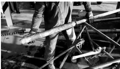
IMAGEN 71. SONDEO CON MUESTRO INALTERADO. (RNM 244, 2016)
