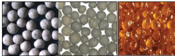
Figura 22. Arenas ISP, LWCP y RCS respectivamente. Foto por Carbo Ceramics Inc.
