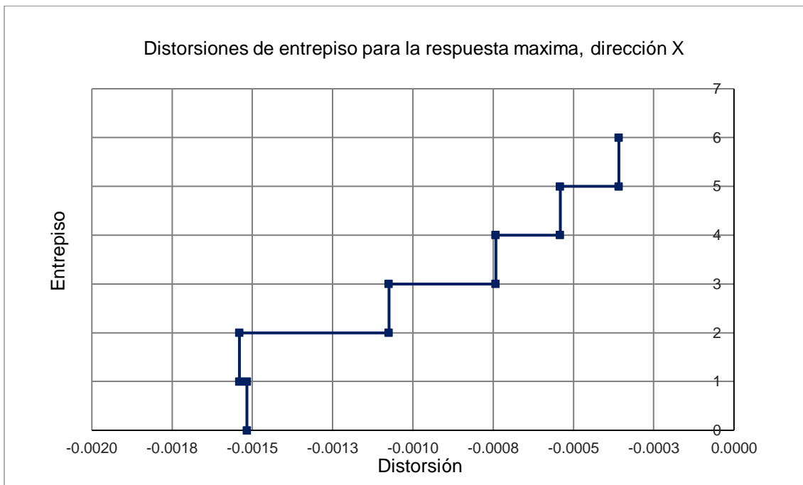
Figura 6.26 Respuesta del modelo M3- PROPUESTA modificado ante el sismo 4, dirección X.
