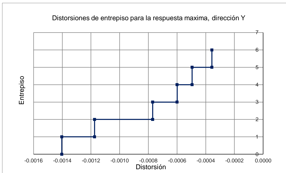
Figura 6.27 Respuesta del modelo M3- PROPUESTA modificado ante el sismo 4, dirección Y.
