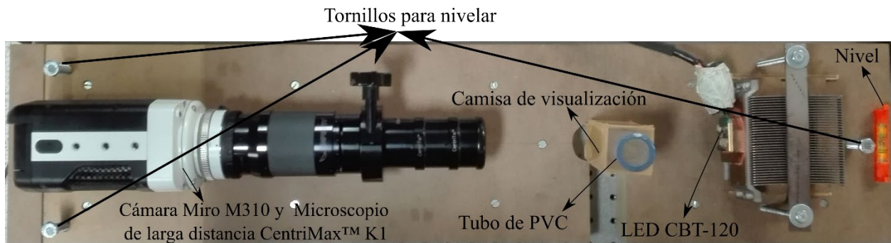
Figura 2.4.- Base de alineación de la Cámara-LED. La base se construyó con dos tableros de MDF de alta densidad de 25 mm de espesor.
