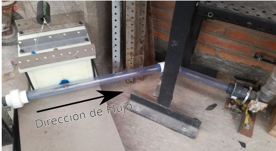
Figura 3.7.- Instalación de la cámara de partículas.
