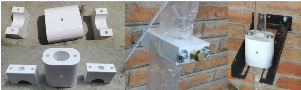
Figura 3.2.- Izquierda, puerto de medición desarmado y cople de tubo, centro puerto de medición armado en el tubo de acrílico y derecha, montaje de cople con tubo fijo a soporte de pared.
