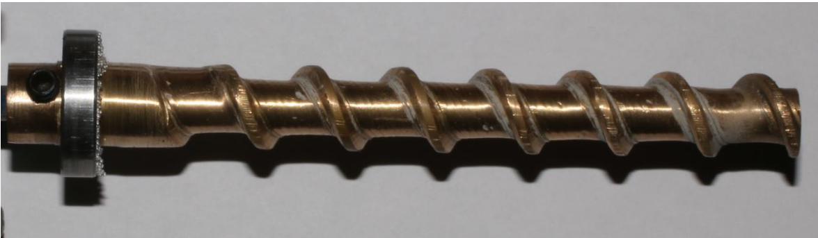
Figura 3.4.- Tornillo sinfín, maquinado en bronce.
