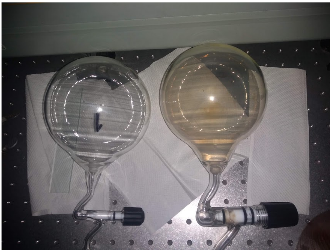
Figura 5. 4. Atmósfera con N_2 - CH_4 - CO (90 %-8 %-2 %) antes (izquierda) y después (derecha) de su irradiación.
