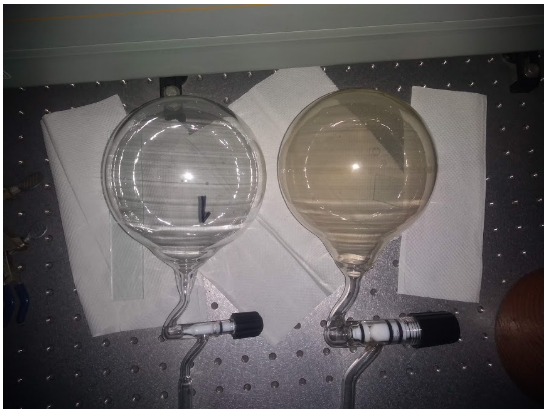
Figura 5. 2. Atmósfera con N_2-CH_4 (90 %-10 %) antes (izquierda) y después (derecha) de su irradiación.
