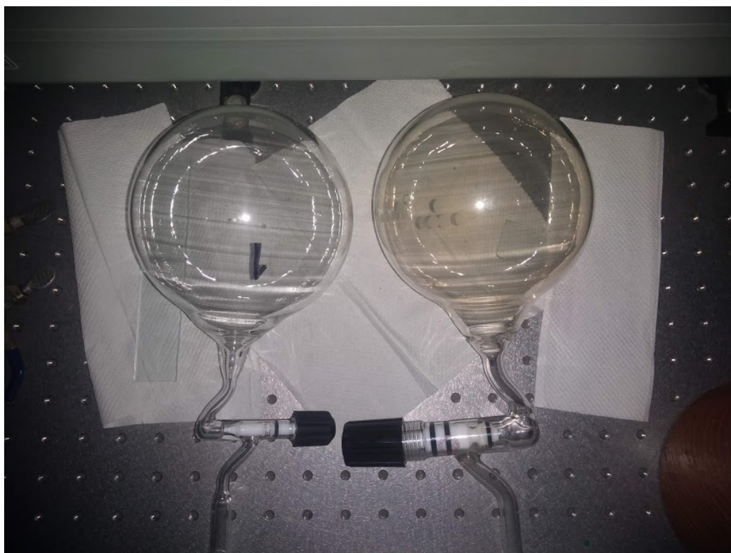
Figura 5. 6. Atmósfera con N 2 -CH 4 -CO 2 (90 %-8 %-2 %) antes y después de su irradiación.
