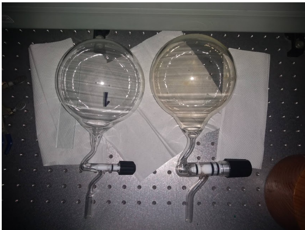
Figura 5. 8. Atmósfera con N_2 - CH_4 - O_2 (90 %-8 %-2 %) antes y después de su irradiación.
